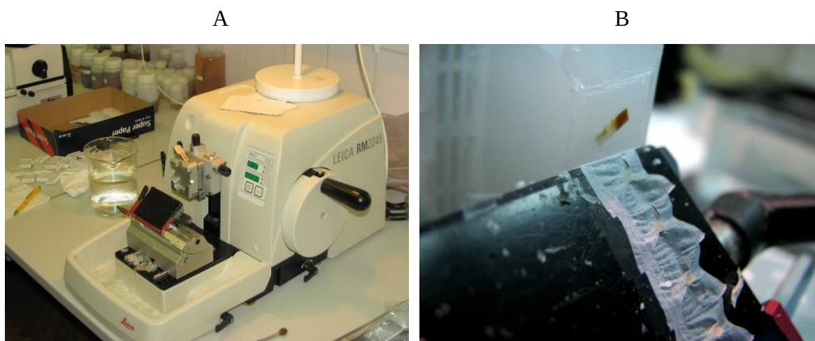
Slika 12: A – Polavtomatski rotacijski mikrotom; B – Odrezovanje rezin na rotacijskem mikrotomu.
