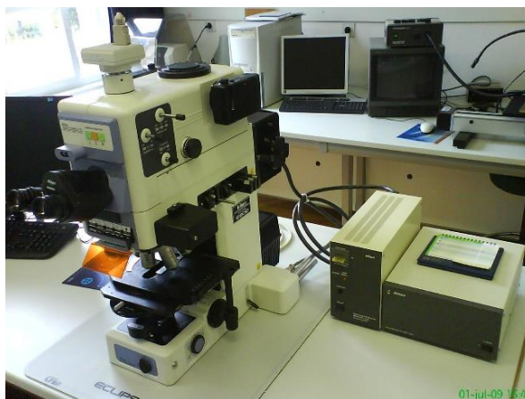
Slika 20: Mikroskop Nikon Eclipse E800 za analizo mikroskopskih preparatov.
