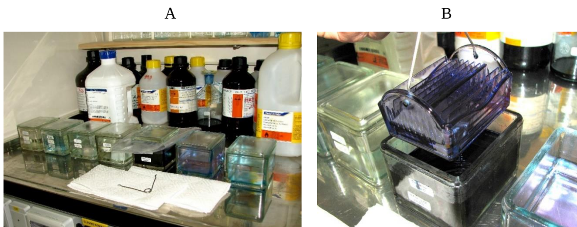
Slika 16: A – Steklene posode posameznih raztopin za barvanje preparatov; B – Barvanje preparatov v stekleni košarici.
