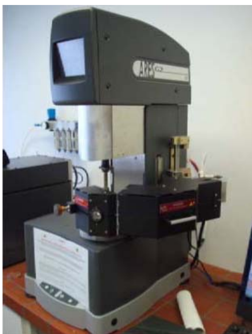
Slika 4: Merjenje reoloških lastnosti z reometrom ARES-G2
