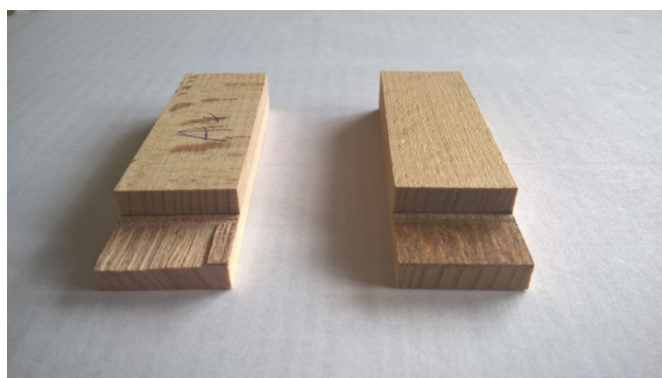
Slika 8: Ocena loma po lesu; 100 % lom po lesu (levo) in 0 % lom po lesu (desno)
