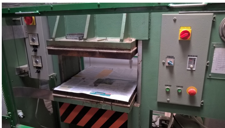
Slika 5: Električno ogrevana stiskalnica za lepljenje preskušancev
