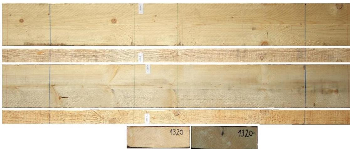
Slika 25: Primer označevanja nosilca s strženom
