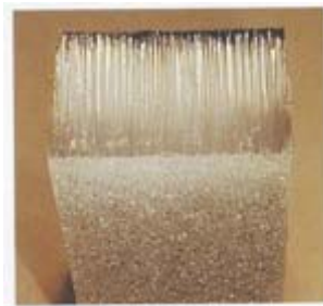
Slika 19: Prosojna toplotna izolacija (Zbašnik-Senegačnik in Kresal, 2004)
