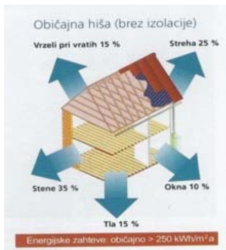
Slika 1: Prikaz izračuna toplotnih izgub na objektu (Nizkoenergijska hiša /.../, 2013)
