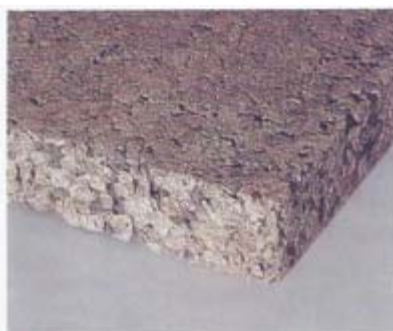
Slika 3: Ekspandirana, impregnirana pluta (Zbašnik-Senegačnik in Kresal, 2004)
