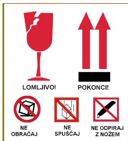
Slika 35: Označevanje omaric s simboli za ustrezno manipulacijo
