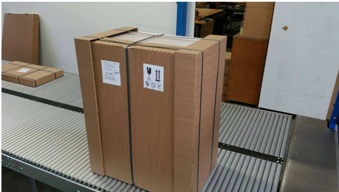
Slika 63: Končno zapakiran element v embalažo dobavitelja in povezano s povezovalnimi trakovi
