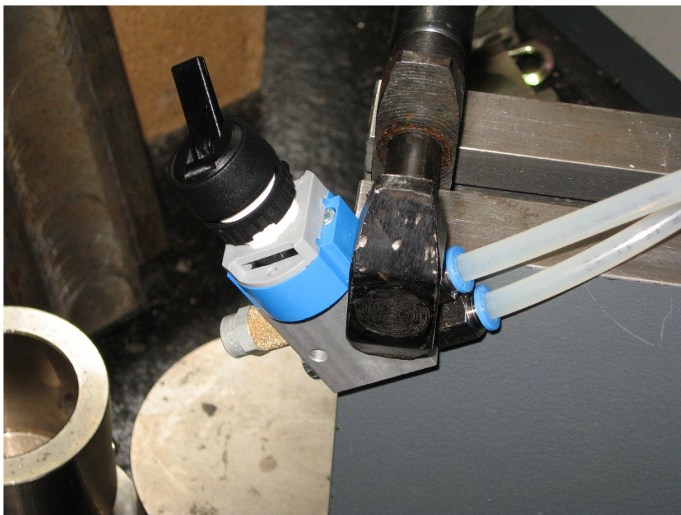
Slika 9: Posebni ventil, ki nam je omogočil sprostitvev tlaka stiskanja med deformacijo, brez odpiranja stiskalnice
