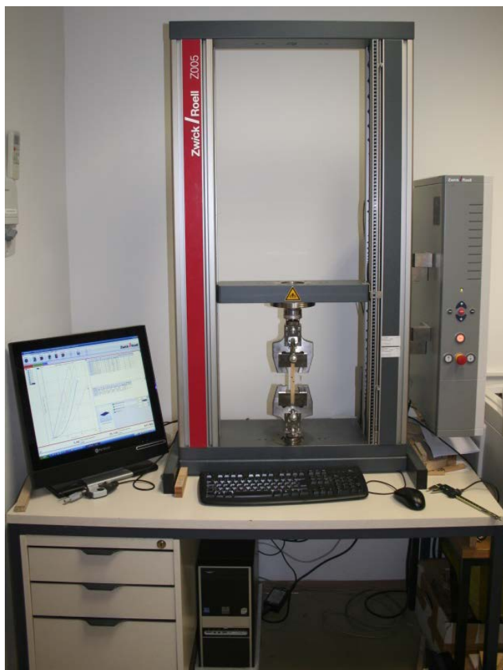
Slika 14. Univerzalni testirni stroj ZWICK/ROELL Z005
