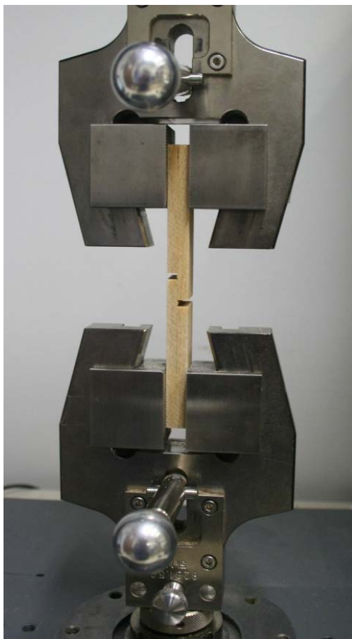
Slika 15. Vpenjalna naprava s preizkušancem na univerzalnem testirnem stroju ZWICK/ROELL Z005
