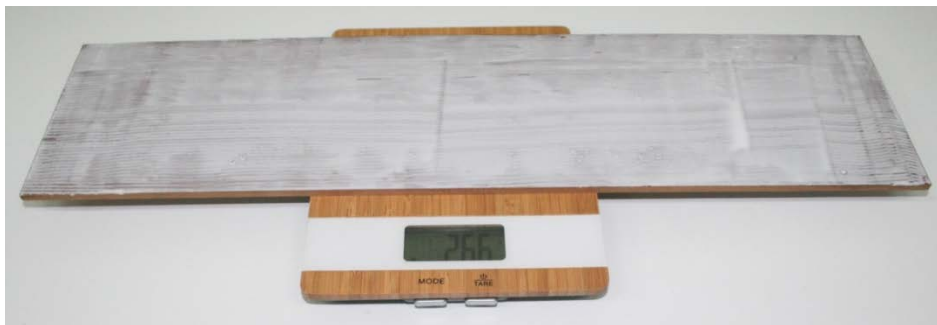
Slika 10. Nanešeno PVAc lepilo na lamelo iz TM bukovine
