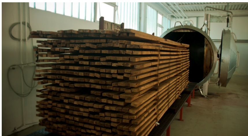
Slika 9. Zložaj termično modificiranega lesa (Rep, 2016)
