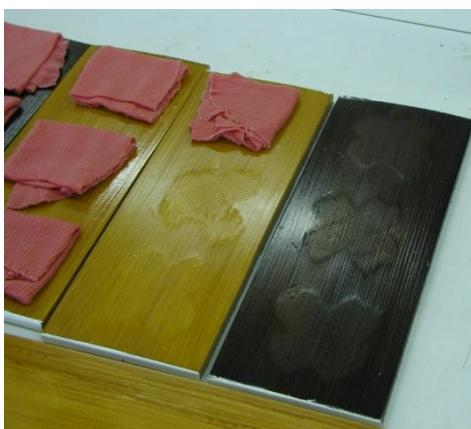
Slika 9: Na zarezane rešetke postavljene prepojene bombažne krpe
