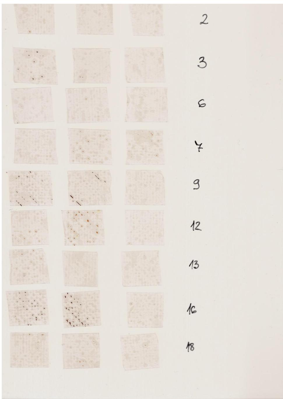
Slika 19: Premazni sistemi, starani po metodi UPS, testirani na mokro oprijemnost po zaključku UPS
