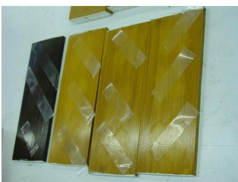
Slika 10: Na prepojene zarezane rešetke nalepljen lepilni trak
