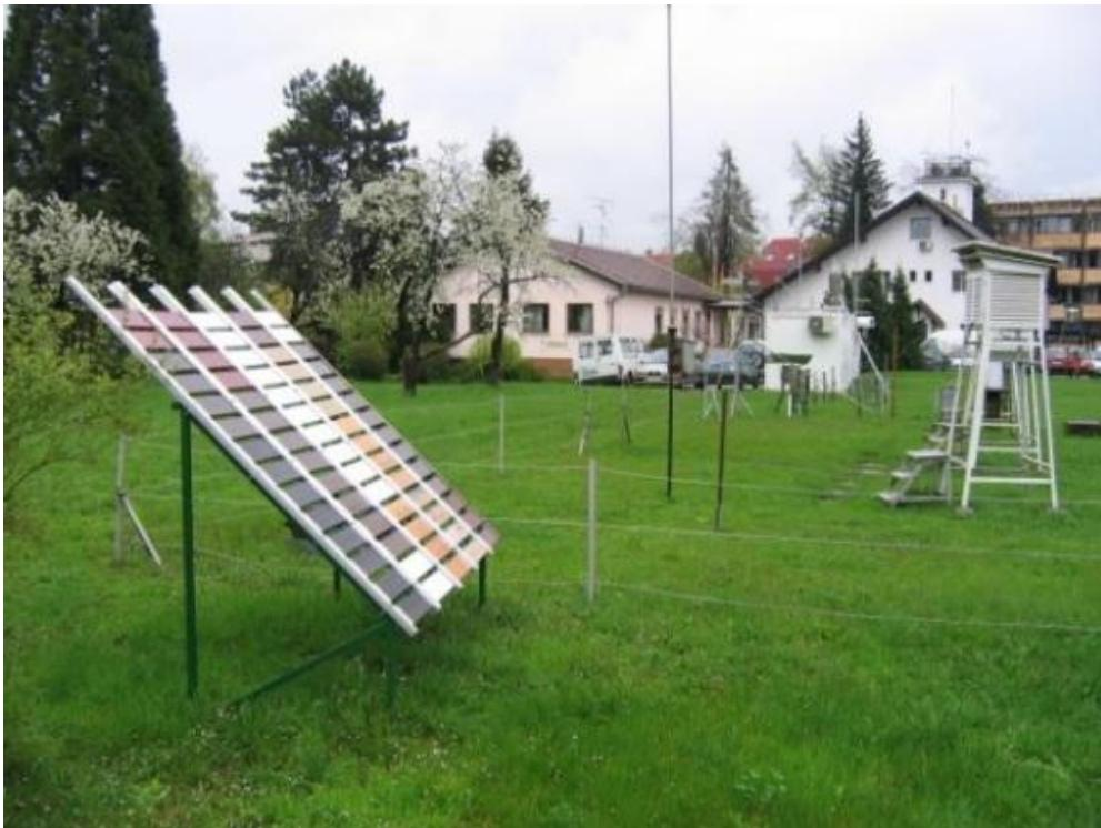
Slika 4: Primer naravnega staranja premaznih sistemov (foto: M. Pavlič)
