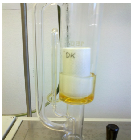
Slika 16: Celulozni tulec v ekstrakcijski celici. Topilo se je med ekstrahiranjem rumenkasto obarvalo.
