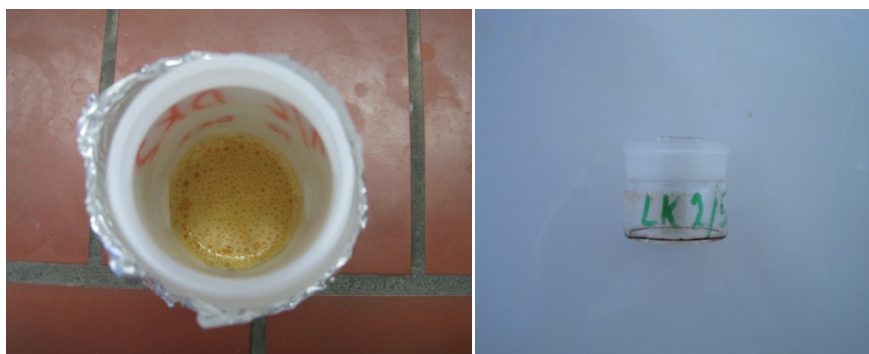
Slika 17: Suh ekstrakt, ki je ostal na dnu prahovke (levo) in tehtiča (desno), ko je topilo izparelo.
