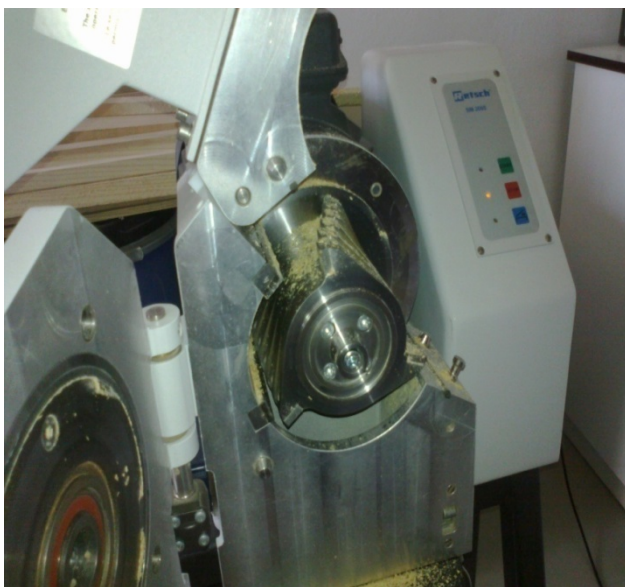
Slika 11: Mlin za mletje Retsch SM 2000, s katerim smo mleli grče.
