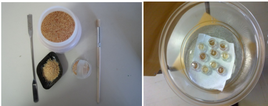
Slika 14: Tehtalna ladjica in drugi pripomočki za tehtanje (levo), hlajenje vzorcev v eksikatorju (desno).
