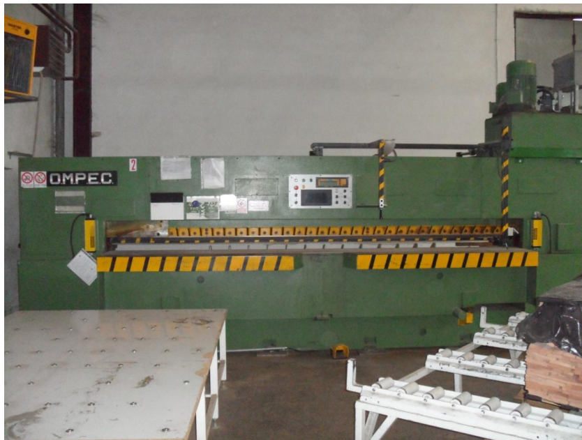
Slika 15: Dvojne škarje za obrez furnirja OMPEC TRO 2 L
