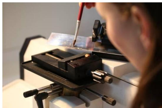
Slika 11: Rezanje tankih rezin lesa na drsnem mikrotomu Leica.
