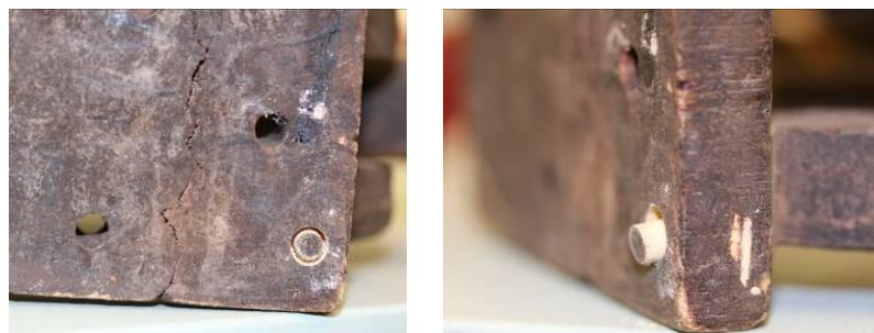
Slika 27: Mesto odvzema vzorca BM62 na spodnjem delu maske.
