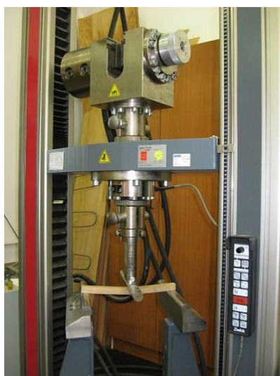
Slika 22: Merjenje upogibne trdnosti na napravi za testiranje mehanskih lastnosti (ZWICK Z100)
