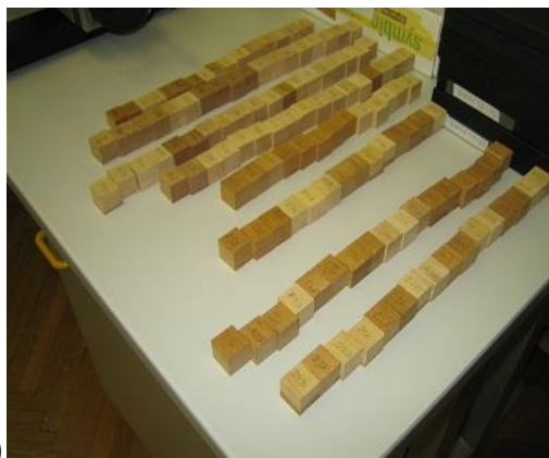
Slika 23: a) Elektronska lupa 52-FT OLYMPUS s stereo okularjem, kamero in merilno mizico LINTAB-5 ; b) Označeni vzorci lesa, pripravljeni za merjenje širin branik
