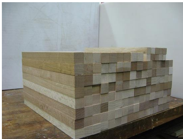
Slika 21: Označeni in uravnovešeni vzorci, pripravljeni za merjenje upogibne trdnosti
