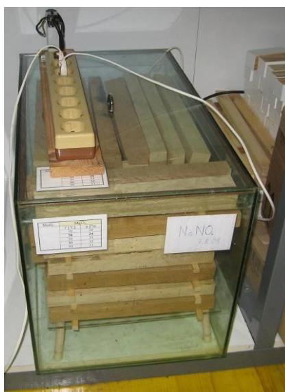
Slika 20: Sušenje vzorcev na ravnovesno vlažnost 12 %
