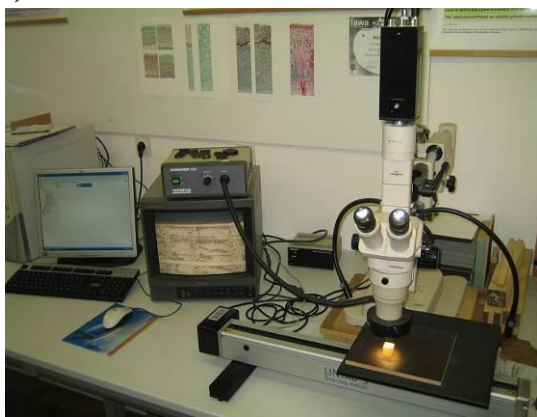
Slika 23: a) Elektronska lupa 52-FT OLYMPUS s stereo okularjem, kamero in merilno mizico LINTAB-5 ; b) Označeni vzorci lesa, pripravljeni za merjenje širin branik
