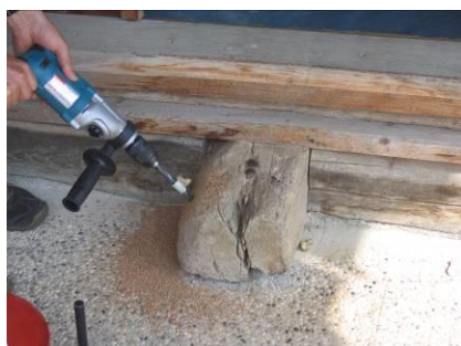
Slika 33: Vrtanje vzorca za dendrokronološko analizo
