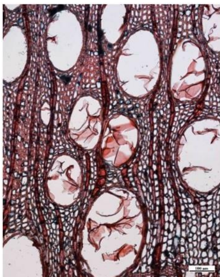
Slika 14: Videz otiljenih trahej v prečnem prerezu hrasta (Kac, 2010)
