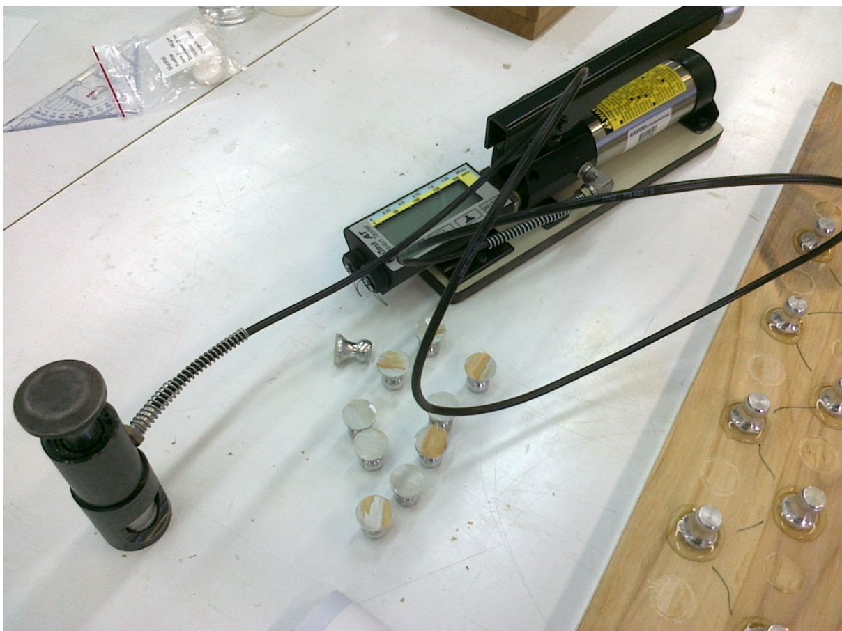
Slika 13: Naprava za merjenje oprijemnosti površinskega premaza na podlago po standardu SIST EN 24624:2004
