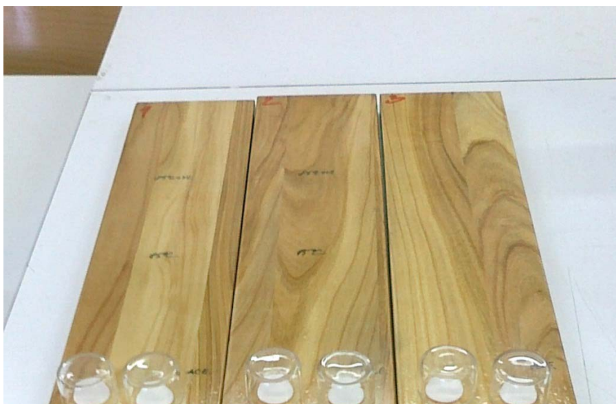
Slika 14: Preizkušanje odpornosti površinskega premaza proti hladnim tekočinam po standardu SIST EN 12720:1997
