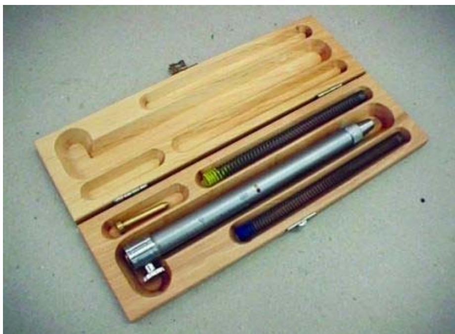
Slika 12: Vzmetni svinčnik za določanje trdote s preizkusom z razenjem po SIST EN ISO 1518:1992
