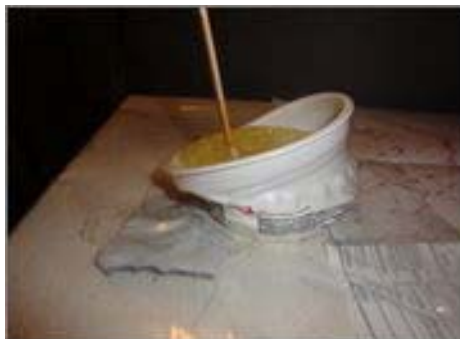
Slika 7: Epoksidni premaz v deformiranem plastičnem lončku (Totisurf, 2011)
