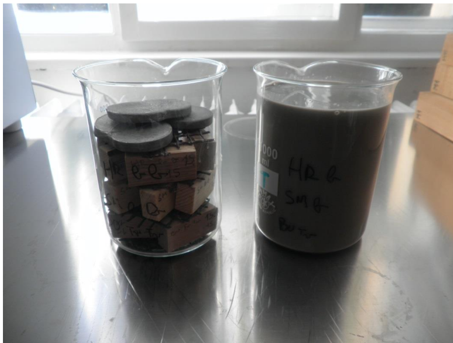
Slika 14: Zlaganje vzorcev v čašo in zalitje s suspenzijo sive gline
