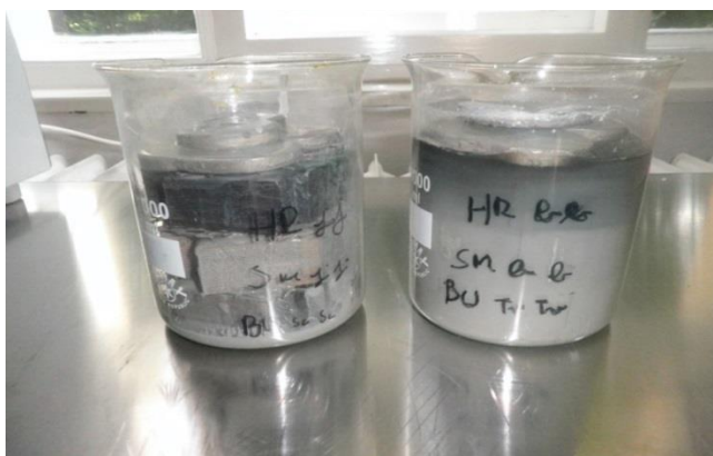
Slika 16: Impregnirani vzorci po impregnaciji z 80 % koncentracijo suspenzije sive gline
