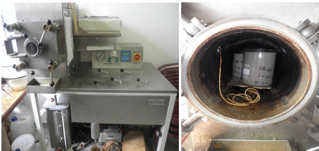
Slika 15: Vakuumsko tlačna impregnacijska komora
