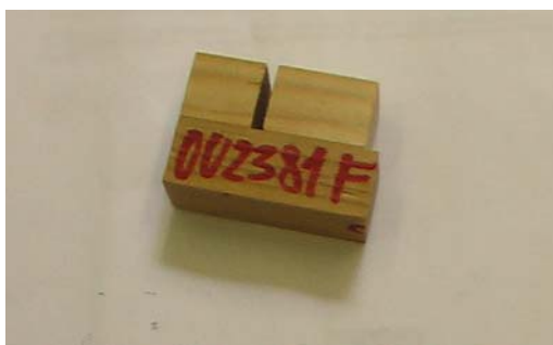
Slika 3: Vzorec za strižni preskus
