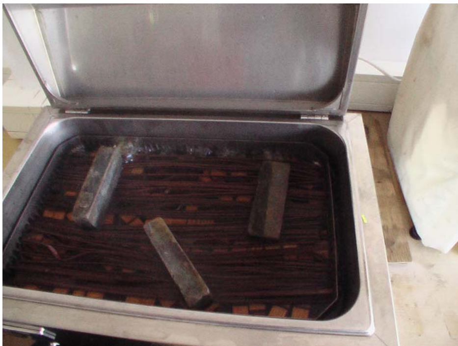
Slika 5: Kuhanje preizkušancev v laboratorijski posodi za kuhanje vzorcev
