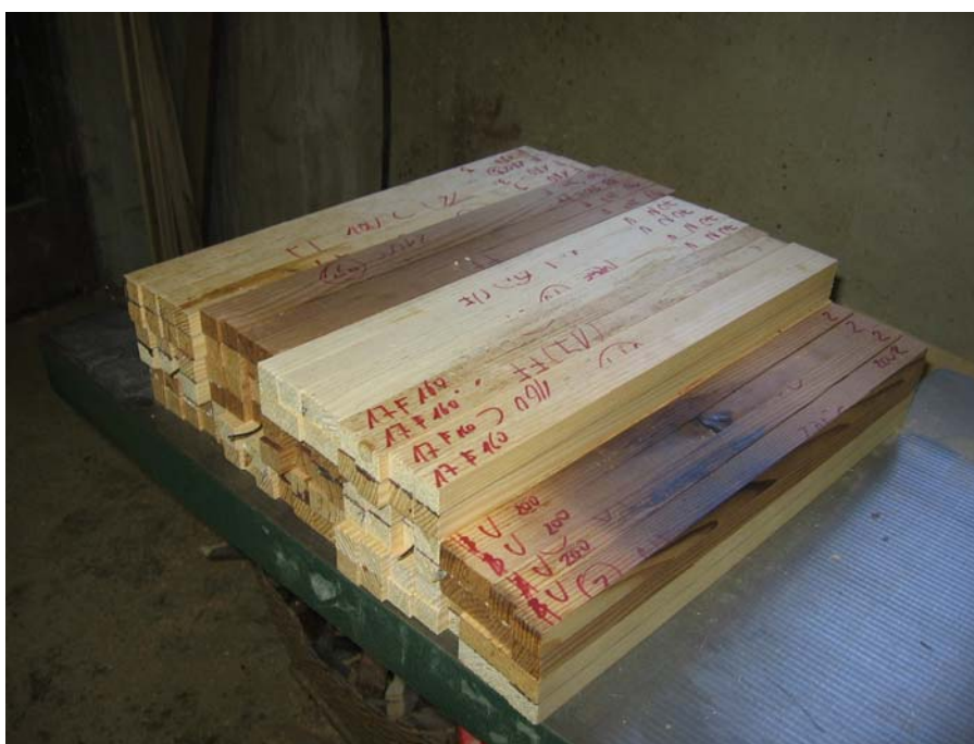
Slika 2: Obarvanje vzorcev kot posledica modifikacije
