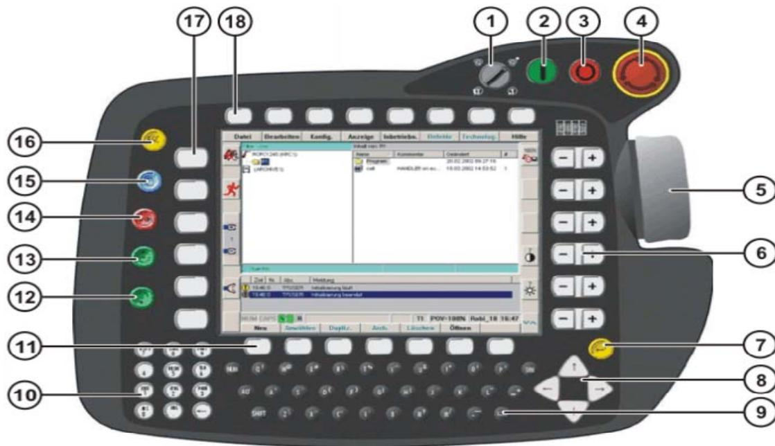
Slika 5: Ročna naprava za programiranje (KUKA System Software, 2008)
