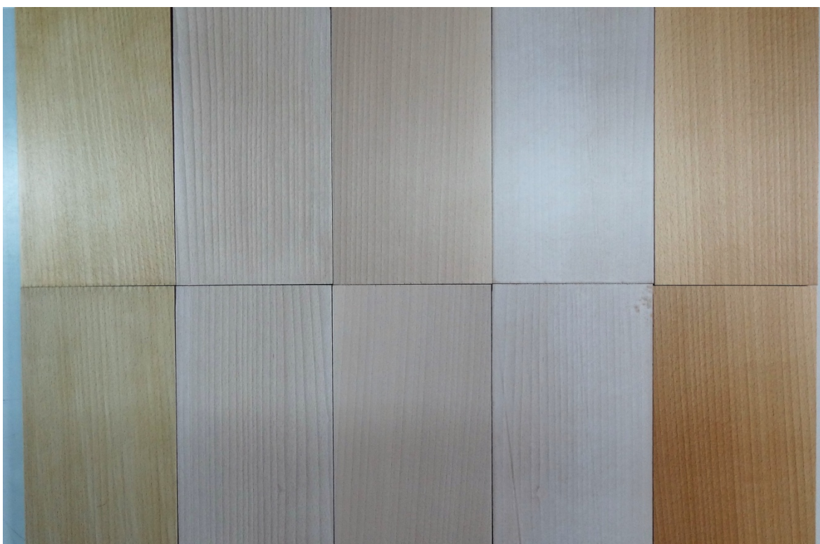
Slika 21: Vzorci od 1-5 (od leve proti desni) po beljenju (zgoraj) in lakiranju (spodaj)
