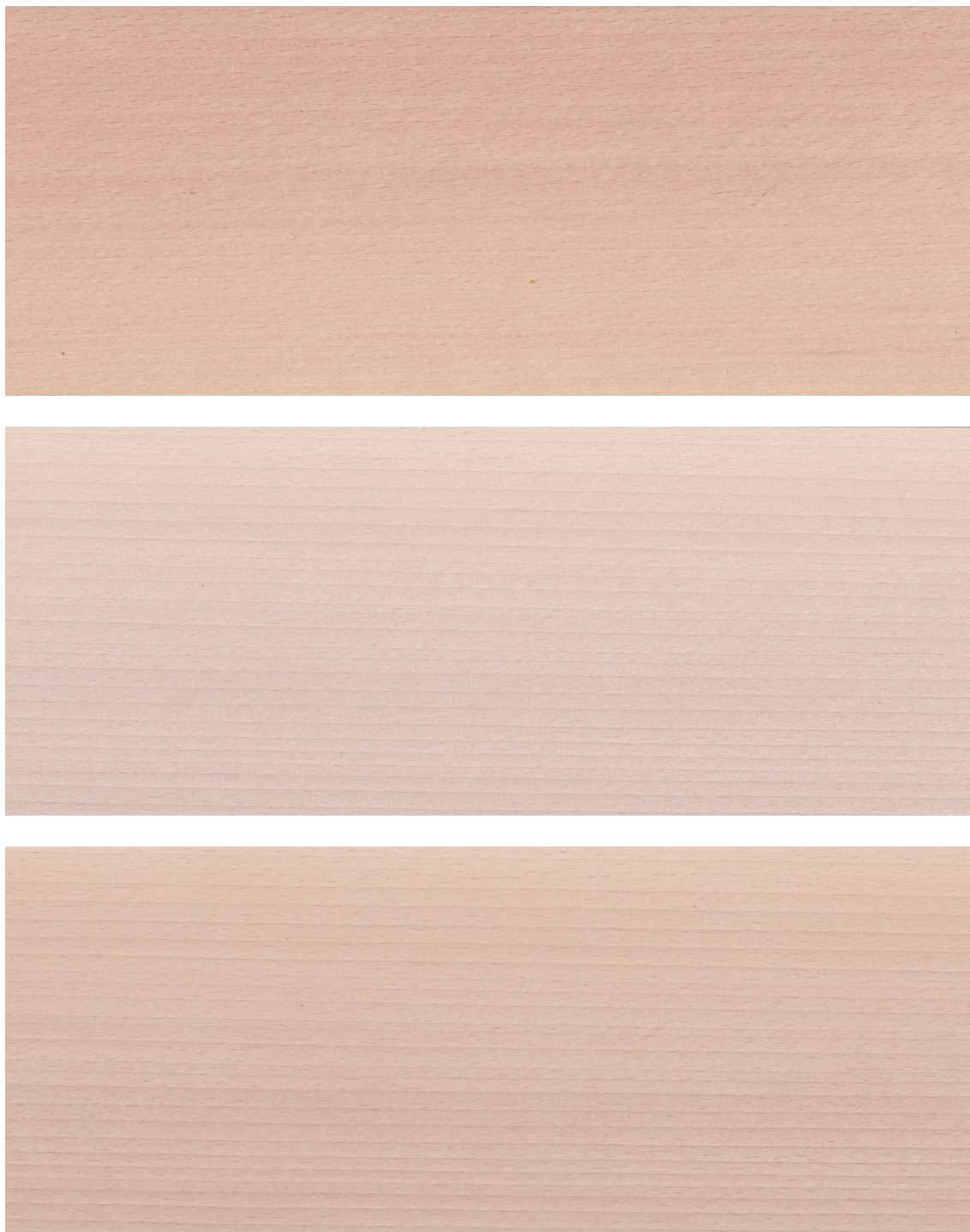
Slika 14: Vzorec 3 pred beljenjem (zgoraj), po belenju (v sredini) in takoj po lakiranju (spodaj)
