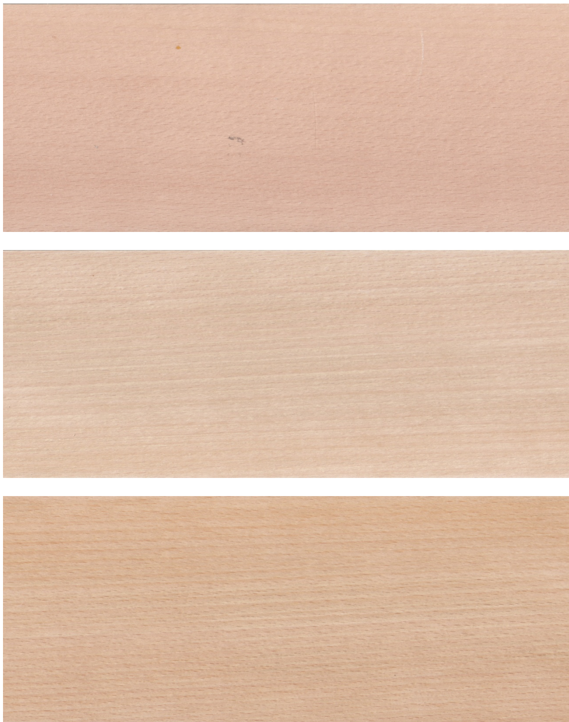
Slika 10: Vzorec 1 pred beljenjem (zgoraj), po belenju (v sredini) in takoj po lakiranju (spodaj)
