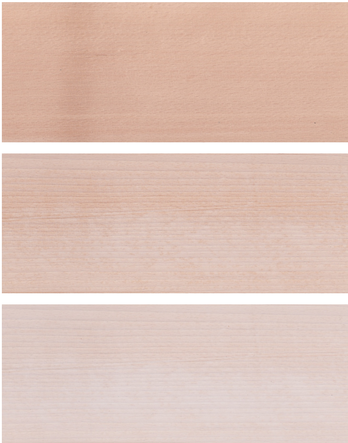
Slika 16: Vzorec 4 pred lakiranjem (zgoraj), po prvem nanosu (v sredini) in po drugem nanosu (spodaj)
