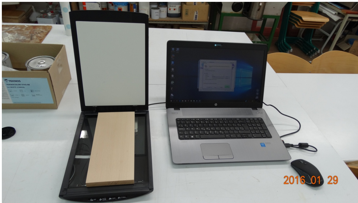
Slika 8: Optično branje površin vzorcev z optičnim bralnikom
