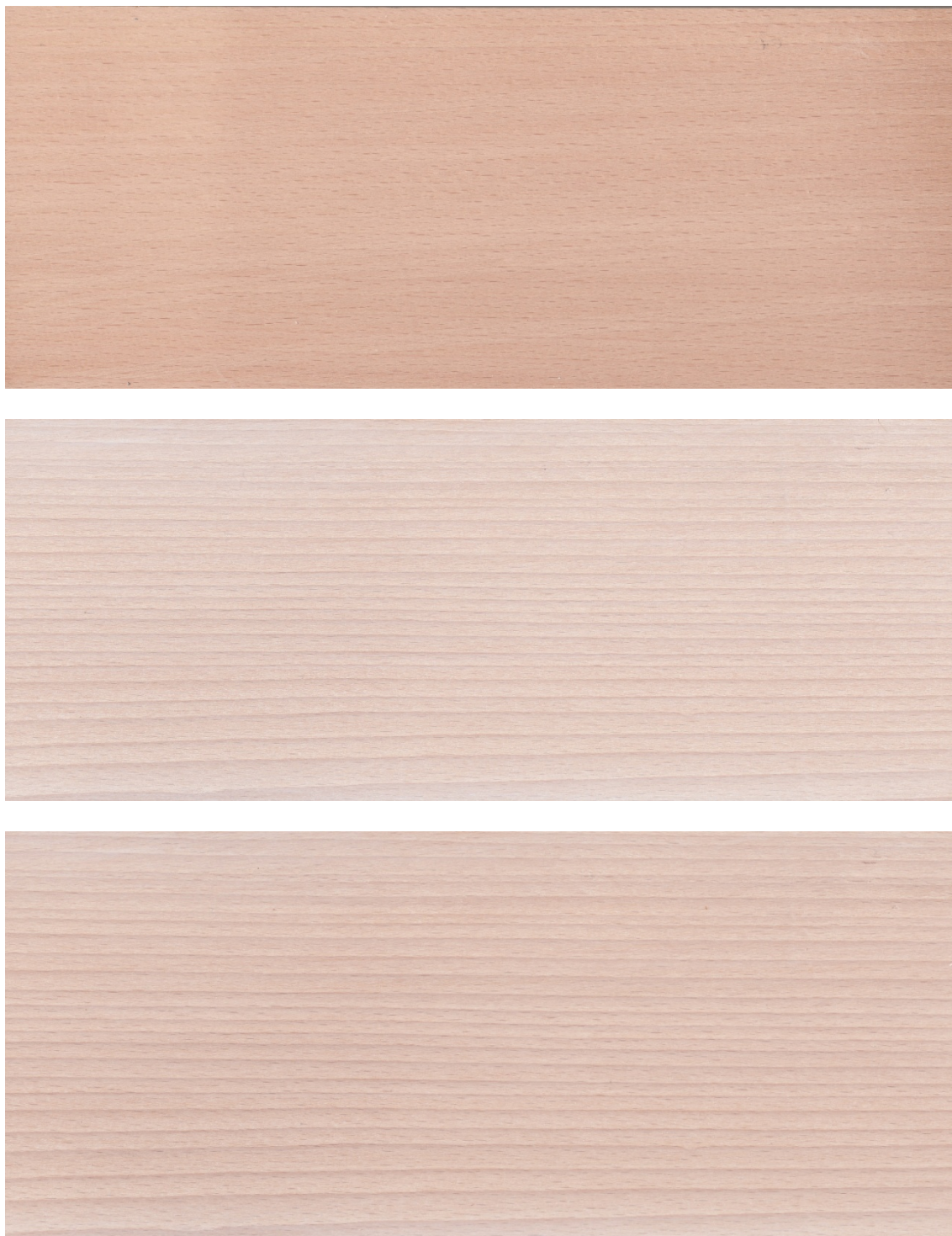
Slika 12: Vzorec 2 pred beljenjem (zgoraj), po belenju (v sredini) in takoj po lakiranju (spodaj)
