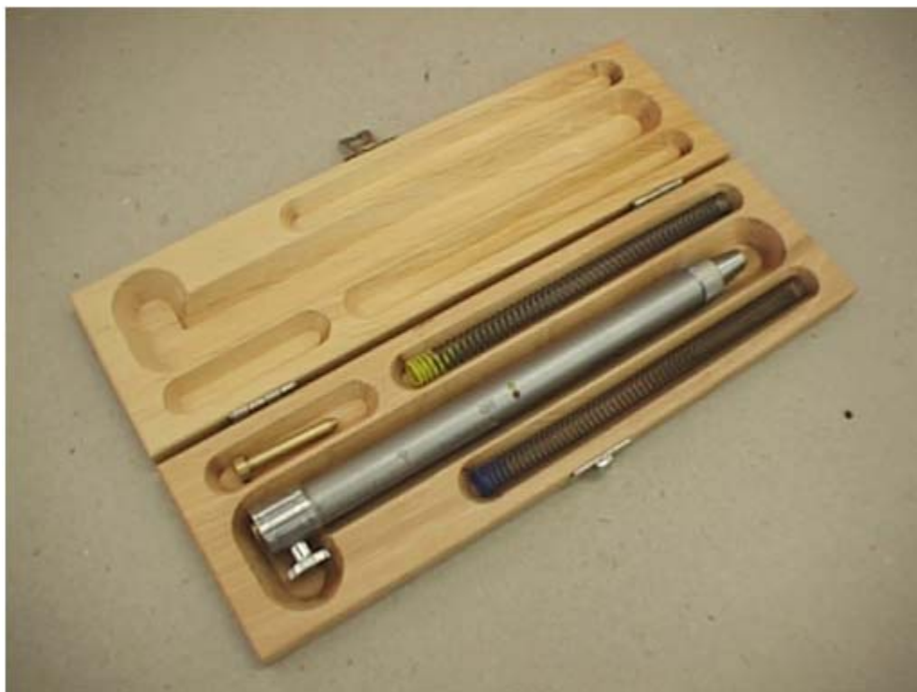
Slika 12: Vzmetni svinčnik za določanje trdote s preskusom z razenjem po SIST EN ISO 1518 ( Pavlič M. in sod., Kakovost površinskih sistemov pohištva slovenskih proizvajalcev, 2003).
