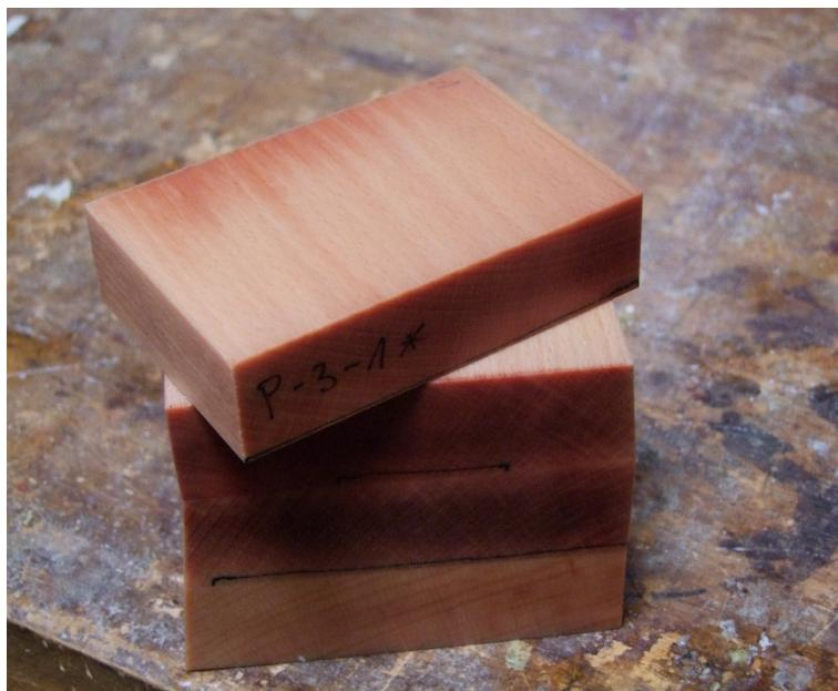
Slika 21: Delaminacija PUR lepilnega spoja v celoti že med namakanjem preizkušancev.
