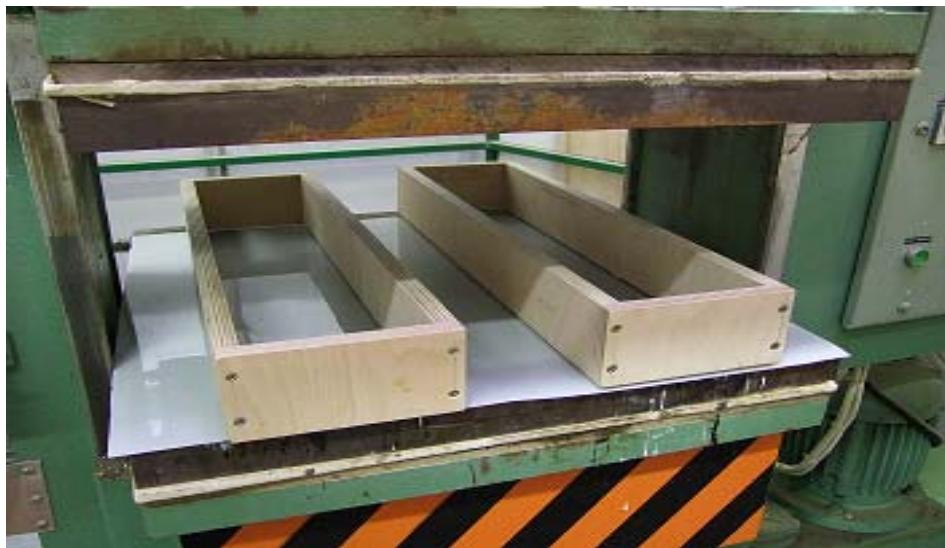
Slika 6: Kalup za lepljenje nosilcev
