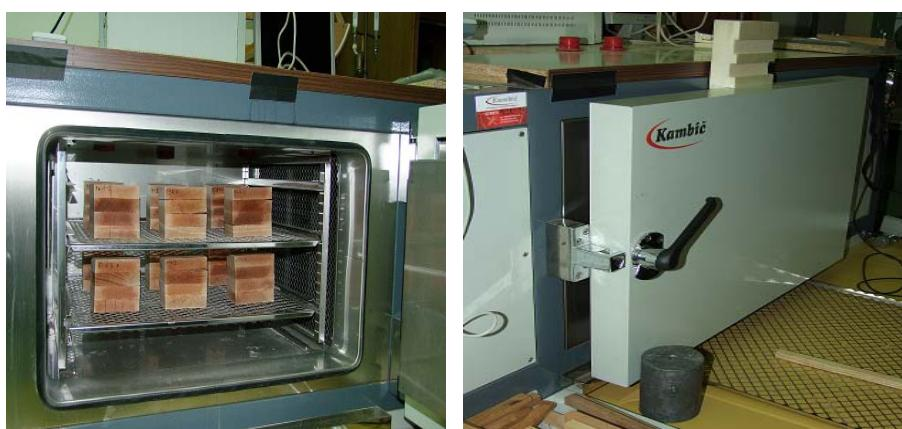
Slika 12: Sušenje preizkušancev v sušilni komori
