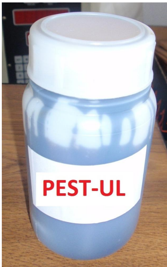
Slika 4: Poliestrsko lepilo na osnovi utekočinjenega lesa
