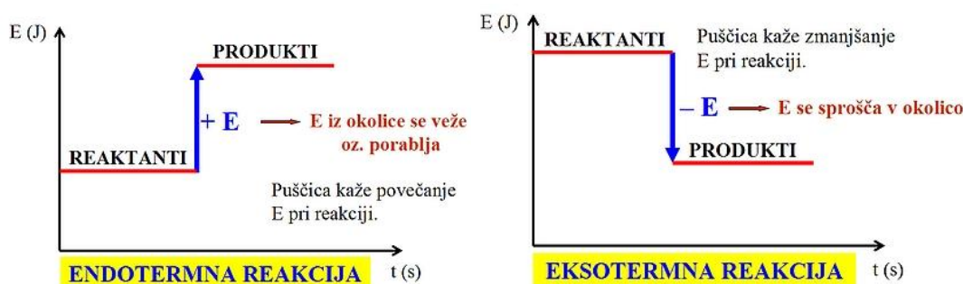
Slika 2: Grafični prikaz energijskih sprememb pri eksotermni in endotermni reakciji
