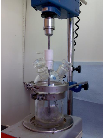
Slika 2: Stekleni reaktor z zunanjim grelcem in mešalom
