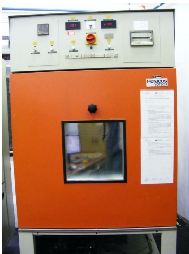
Slika 15: Klimatizacijska komora za kondicioniranje preskušancev
