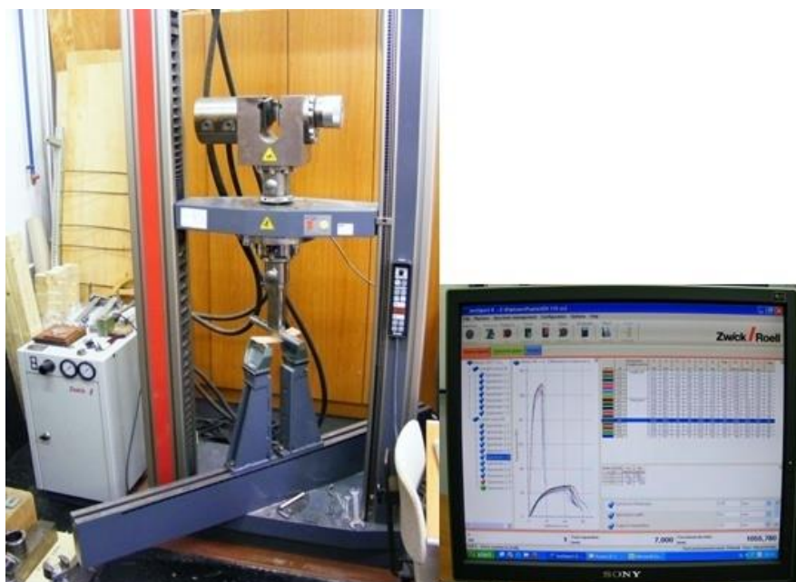
Slika 16: Testirni stroj Zwick Z100 za ugotavljanje upogibne trdnosti in modula elastičnosti (levo) in program »testXpert II« (desno)
