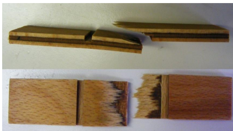
Slika 14: Nepravilen lom preskušanca po zunanjem furnirju (izločenameritev)
