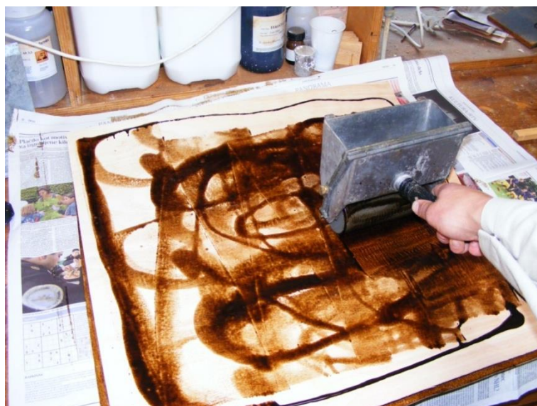
Slika 3: Razporeditev lepilne mešanice po površini furnirja z ročnim valjčkom
