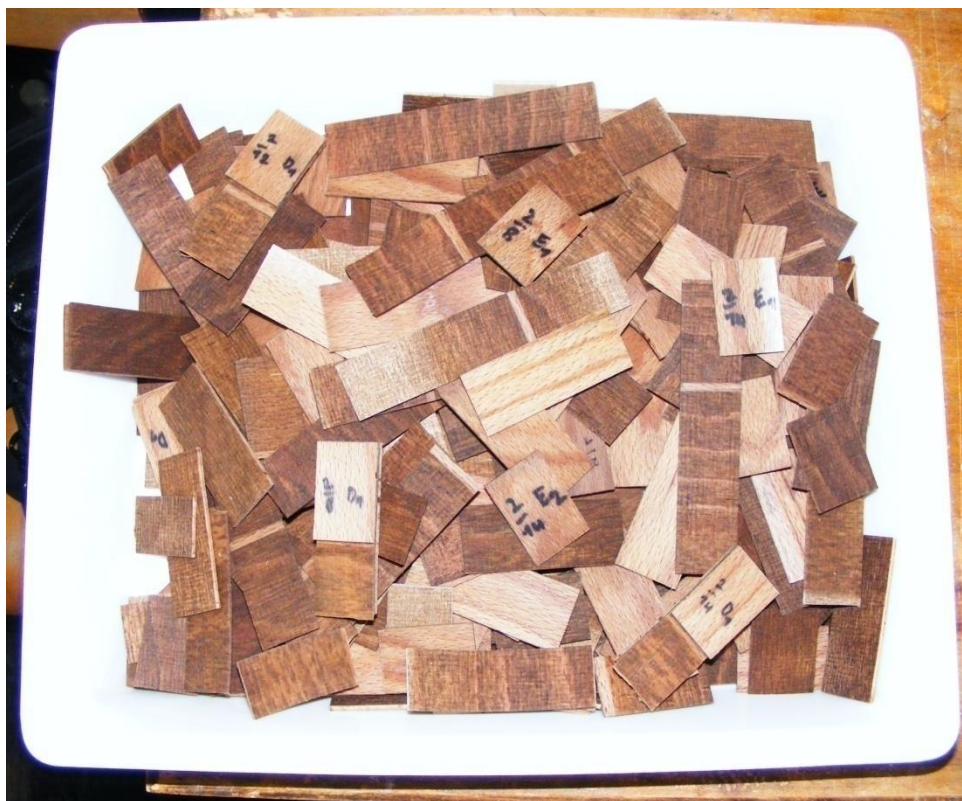
Slika 10: Razpadli strižni preskušanci med kuhanjem
