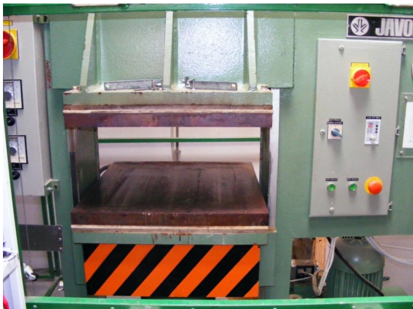
Slika 1: Laboratorijska stiskalnica za vroče lepljenje
