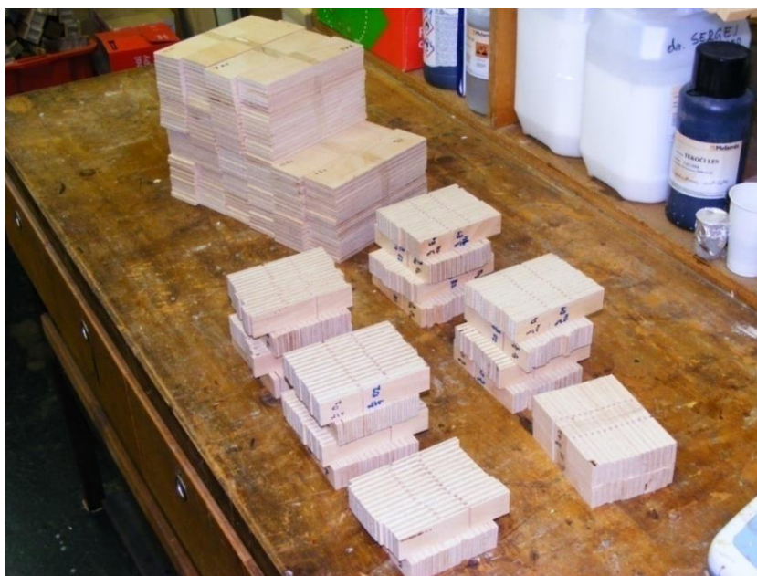
Slika 5: Izžagani preskušanci za upogibno in strižno trdnost 1.serije iz 10 zlepljenih plošč
