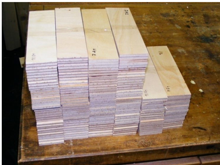
Slika 7: Preskušanci iz furnirne vezane plošče za ugotavljanje upogibne trdnosti
