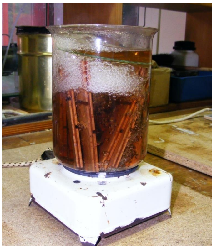
Slika 9: Kuhanje strižnih preskušancev na el.kuhalniku v stekleni čaši z vrelo vodo
