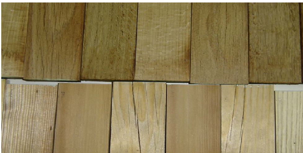
Slika 28: Značilne poškodbe različnih lesnih vrst in različnih orientacij po 500 urah obremenjevanja z UPS: Zgoraj od leve proti desni: bukovina radialno, bukovina tangencialno, hrastovina tangencialno, hrastovina radialno, bukovina tangencialno, hrastovina tangencialno orientirana. Spodaj od leve proti desni: macesnovina radialno, macesnovina radialno, smrekovina tangencialno, macesnovina radialno, smrekovina tangencialno, ter jesenovina radialno orientirana.
