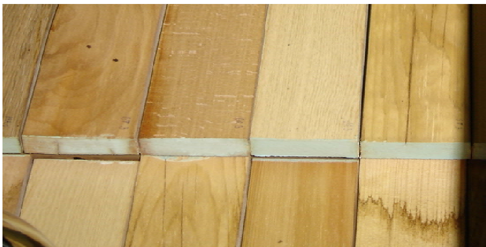
Slika 27: Značilne poškodbe različnih lesnih vrst in različnih orientacij po 100 urah obremenjevanja z UPS: Zgoraj od leve proti desni: hrastovina radialno, bukovina tangencialno, hrastovina tangencialno, hrastovina radialno, smrekovina tangencialno orientirana. Spodaj od leve proti desni: jesenovina radialno, smrekovina tangencialno, bukovina radialno, jesenovina radialno orientirana.
