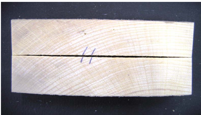
Slika 3.3: Kontrolni vzorec za merjenje notranjih napetosti po izdelavi.
