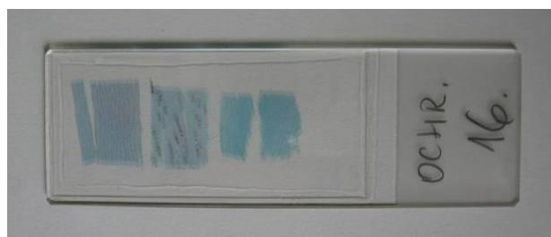
Slika 7: Trajni preparat balze za preiskavo anatomije (prečni, tangencialni, radialni prerez).
