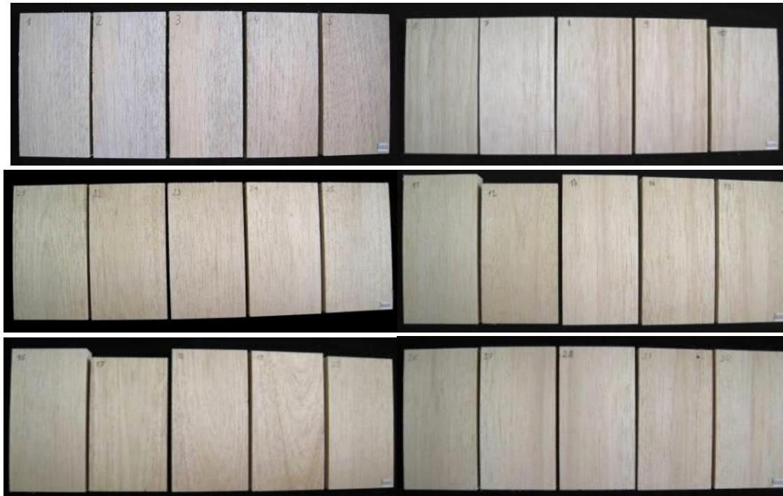
Slika 5: Oštrevljeni in po barvi razdeljeni preizkušnici.
