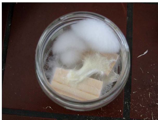
Slika 13: Preraščeni vzorci lesa z micelijem po 16 tedenski izpostavitvi
