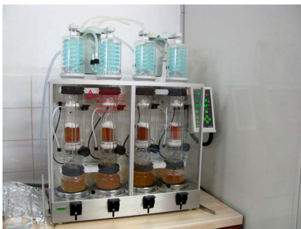
Slika 9: Ekstrahiranje vzorcev lesa v Soxhletovi aparaturi
