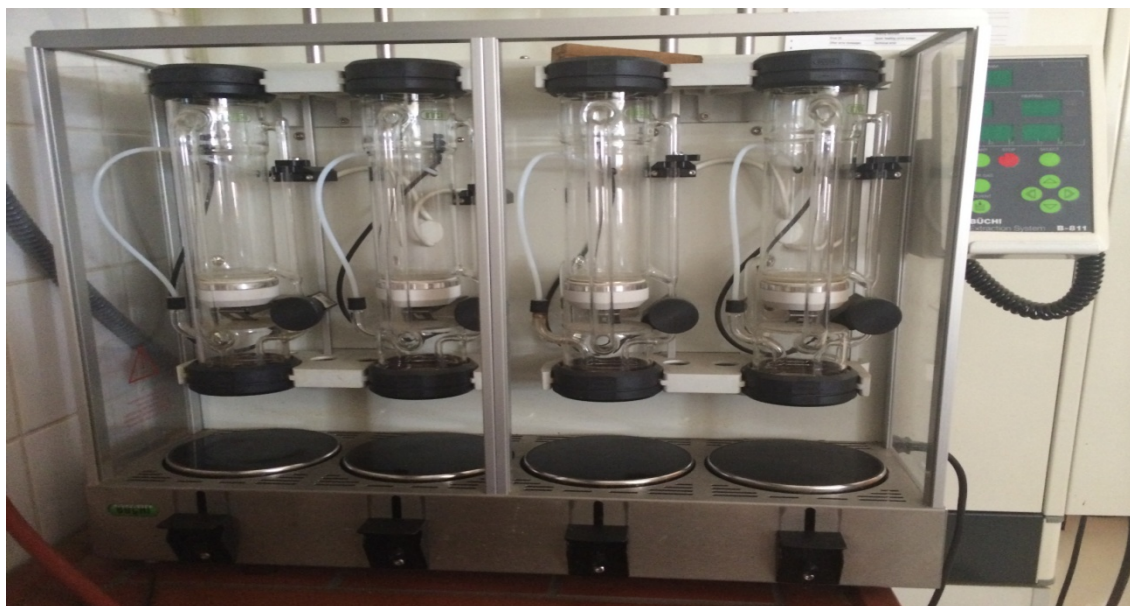
Slika 7: Naprava s katero smo določali delež ekstraktivov, Büchi B – 811.
