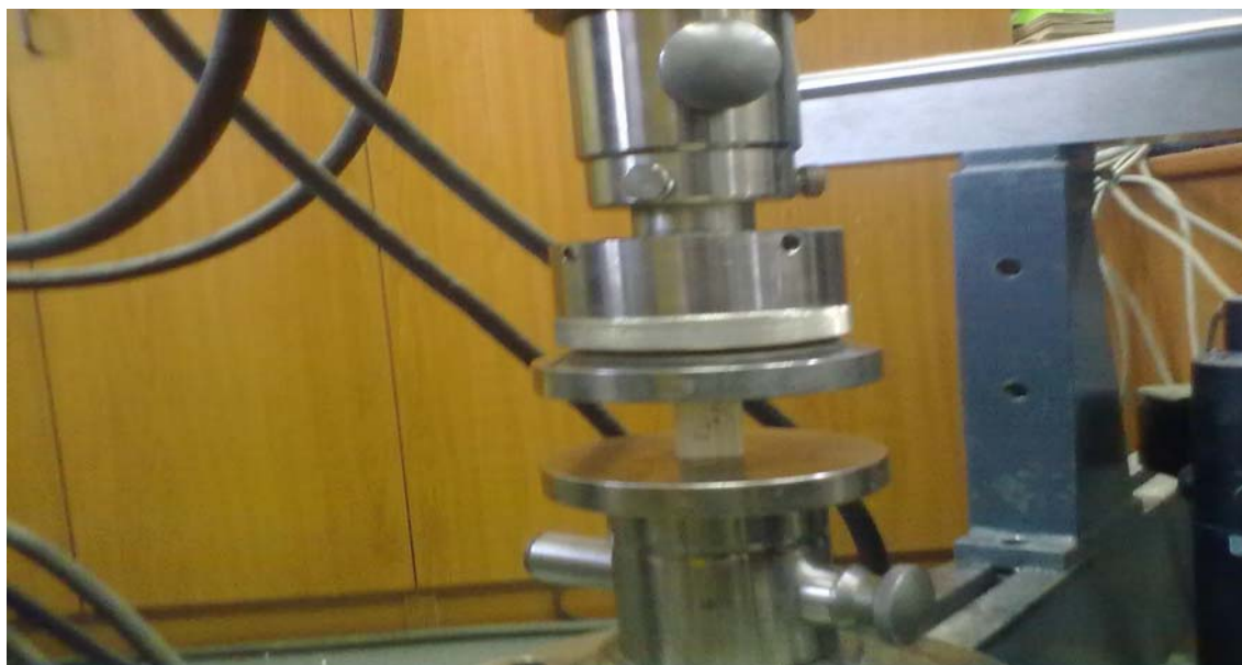
Slika 6: Naprava, s katero smo določali tlačno trdnost, Zwick-Roell Z100.
