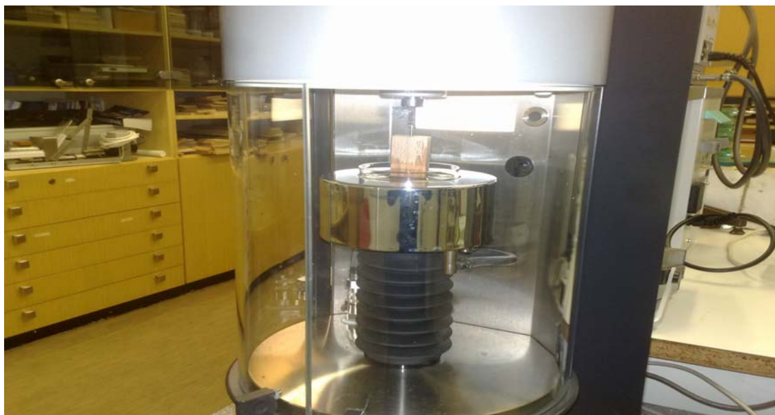
Slika 8: Naprava za določanje kratkotrajnega navzema vode, Krüs 100.
