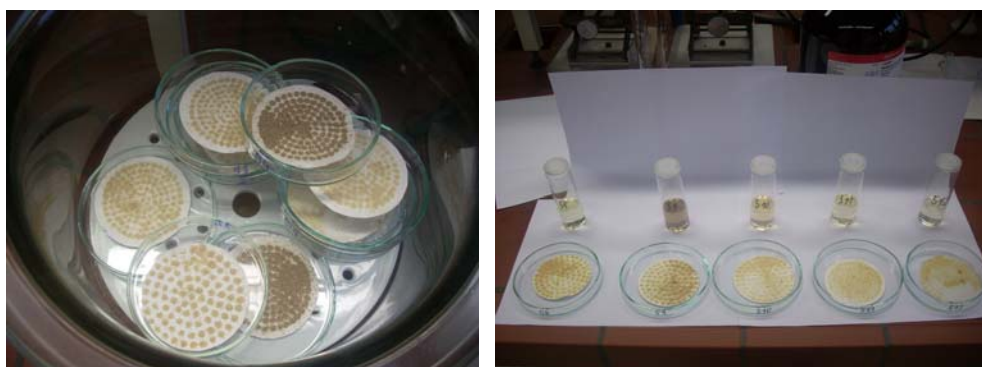
Slika 11: Prikaz suhe filterne pogače v eksikatorju (levo) ter tekoč filtrat in suha filterna pogača (desno)
