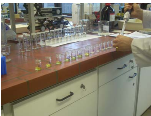
Slika 13: Prikaz dodatka raztopine \text{Na}_2\text{CO}_3 v časovnem razmerju 1 min do 8 min
