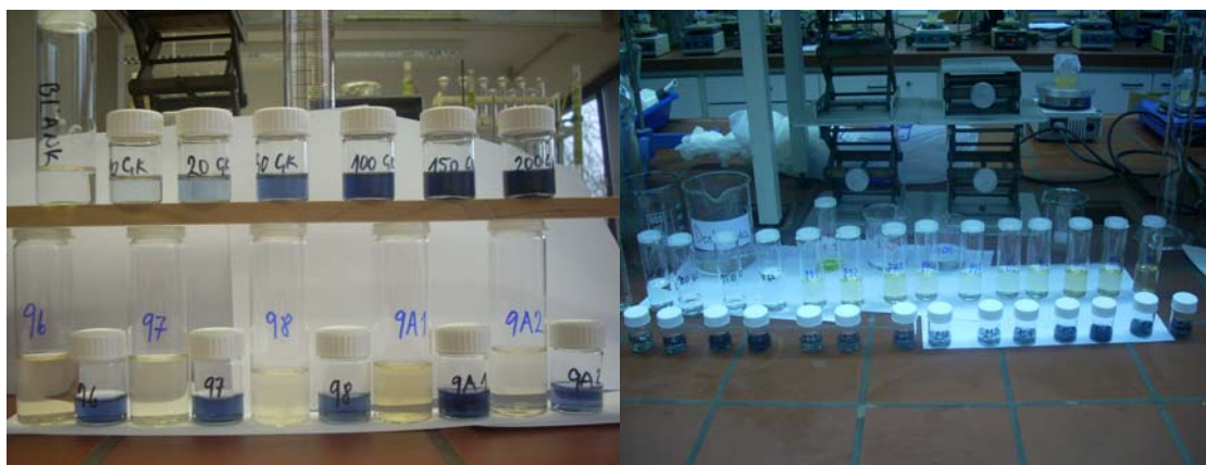
Slika 14: Vzorci po dodanem Na 2 CO 3 (spredaj na sliki) in osnovna raztopina standardne galne kisline (zadaj na sliki) – levo in tekoč ekstrakt in pripravljene vzorci za umeritveno krivuljo - desno
