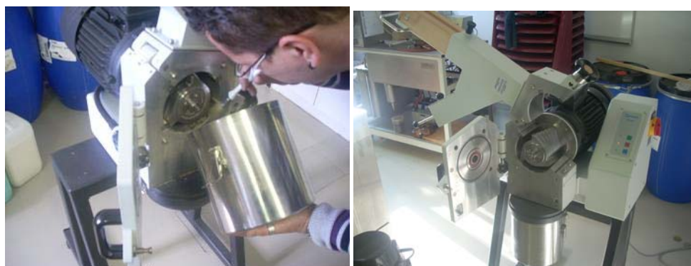
Slika 6: Pobiranje vzorca iz mlina (levo) in Mlin Retsch SM 2000 (desno)
