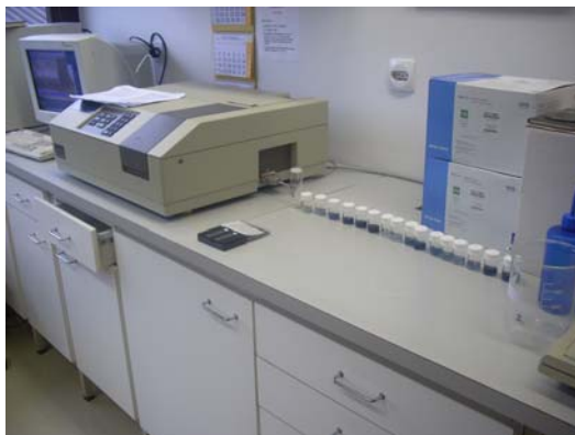
Slika 15: UV-Vis spektrofotometer in sveže pripravljene raztopine reagentov in lesnega ekstrakta, sveže pripravljene zmesi standardnih raztopin galne kislinske in reagentov, ter slepi vzorec.
