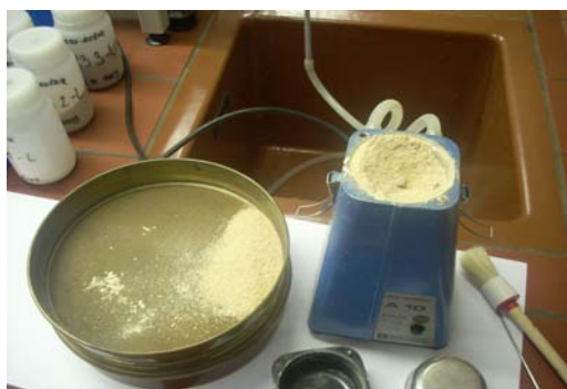
Slika 7: Laboratorijski mlinček in frakcija, ki je ostala na situ mreže 0,4 µm
