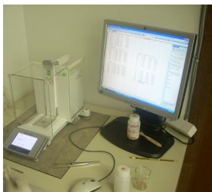
Slika 8: Laboratorijska tehnica Mettler Toledo XS, ki smo jo uporabili za gravimetrično analizo vzorcev
