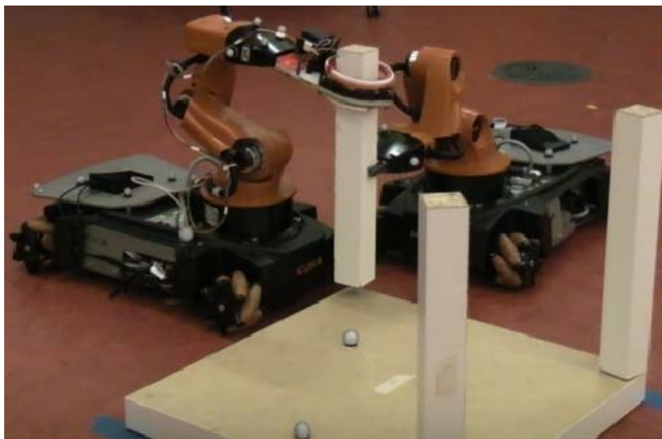
Slika 11: Avtomatsko sestavljanje pohištva (Klampfer in Curk, 2008)
