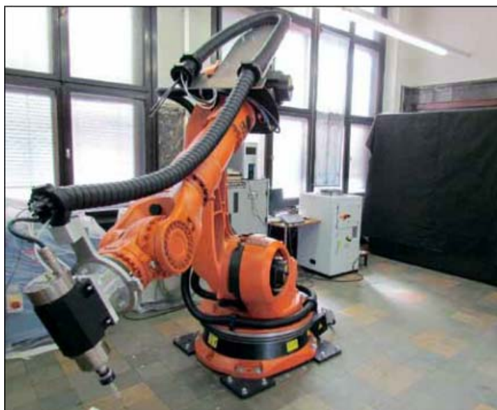
Slika 15: Robotska celica s komponentami in frezalno glavo (Tratar in sod., 2011)
