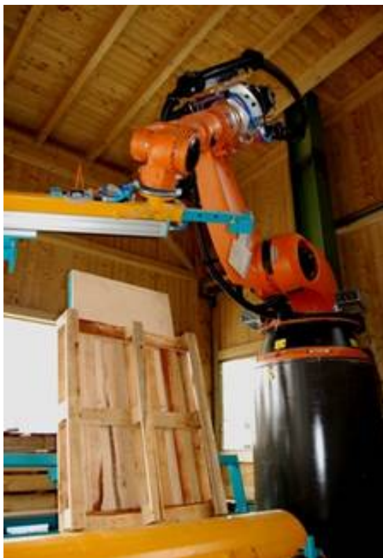
Slika 14: Uporaba robota pri izdelavi palet (IFR, 2014b)
