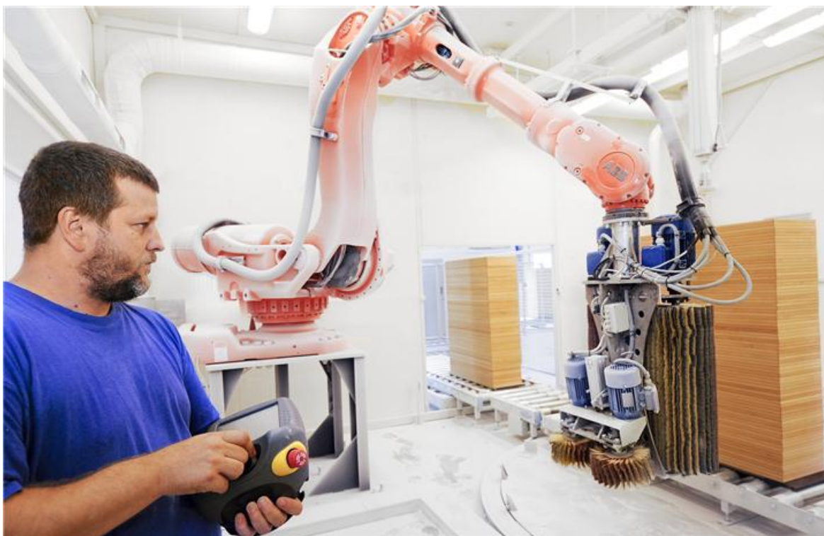
Slika 13: Uporaba robota za brušenje robov (IFR, 2014a)
