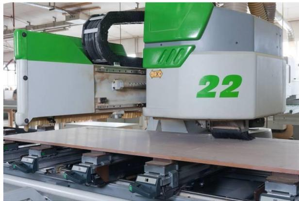
Slika 8: CNC večvretenski vrtni stroj za vrtanje in mozničenje
