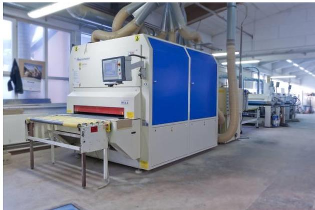
Slika 9: CNC kontaktni brusilni stroj za brušenje furnirja in laka
