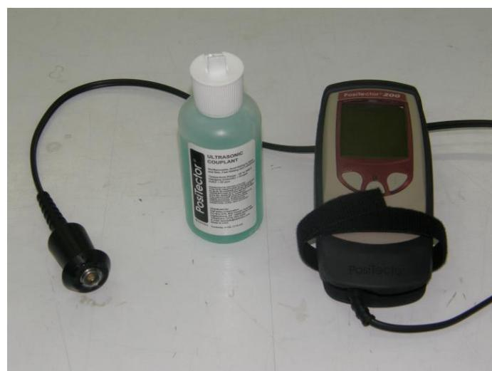
Slika 10: Ultrazvočni merilnik DeFelsco ProsiTector 200
