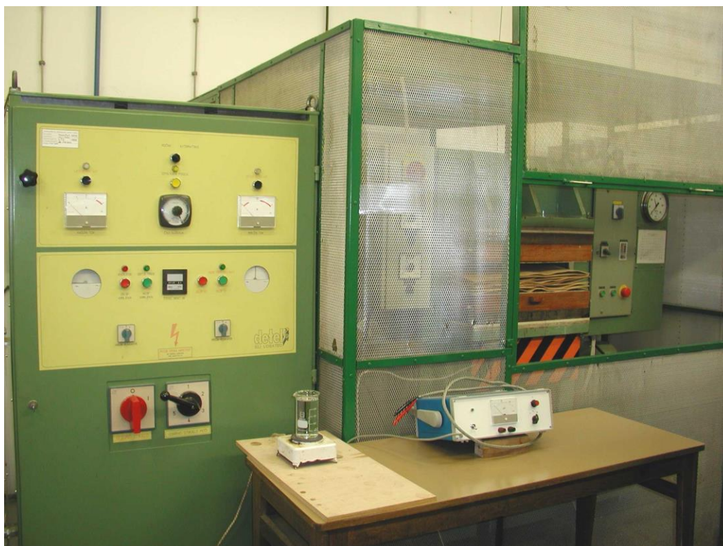
Slika 7: Primer VF stiskalnice pred pričetkom stiskanja večslojne furnirne vezane plošče
