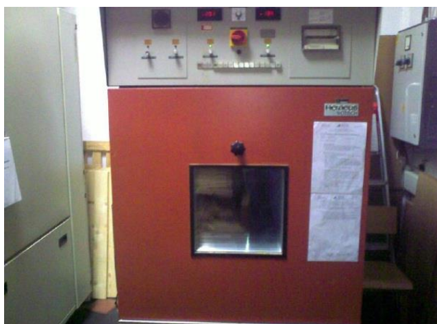
Slika 15: Klimatiziranje preskušancev v komori pri normalnih pogojih, T = 20 °C, RZV = 65 % (relativna zračna vlaga)
