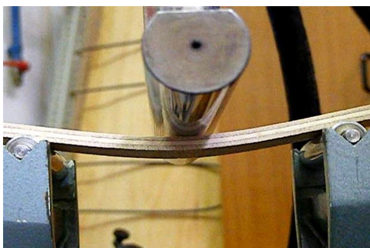
Slika 19: Ugotavljanje upogibne trdnosti in modula elastičnosti na trgalnem stroju Zwick Z100
