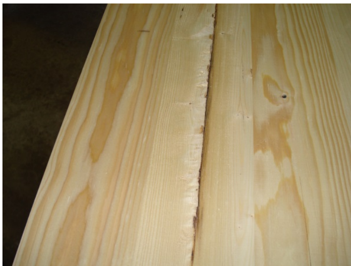
Slika 32: Prikaz preizkušanca s slabimi mehanskimi lastnostmi.
