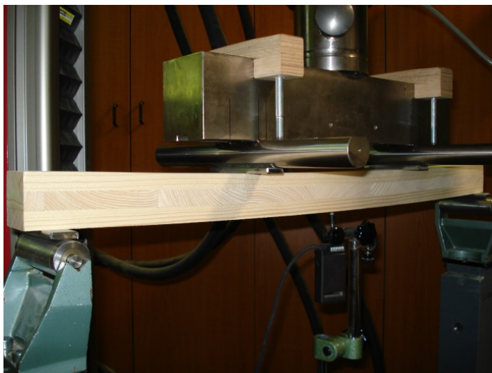
Slika 22: Univerzalni stroj za preizkušanje mehanskih lastnosti lesa Zwick Z100 in pripravljen preizkušaneec za testiranje.
