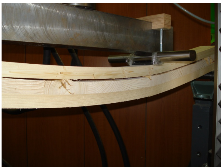
Slika 33: Primer preizkušanca s slabo strižno trdnostjo ploskovnih lepilnih spojev.
