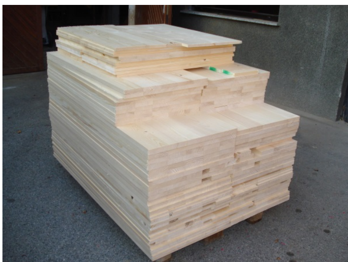
Slika 18: Ploskovni elementi obžagani na točne dimenzije.
