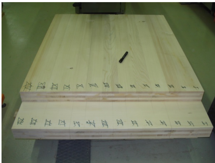
Slika 21: Plošče tipa D, razžagane v preizkušance.
