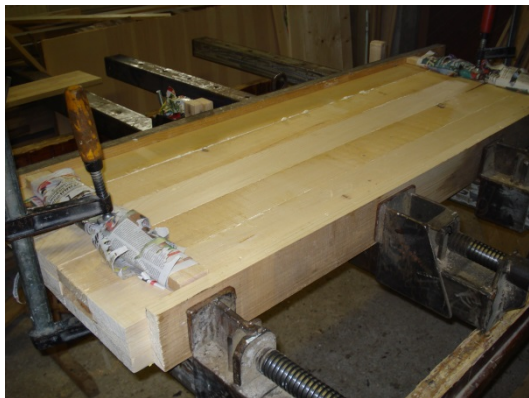
Slika 17: Širinsko lepljenje lamel.
