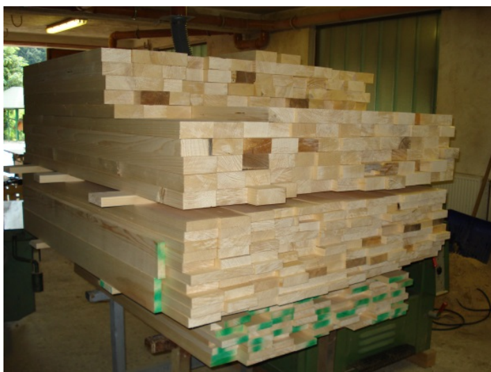
Slika 11: Decimirani in skobljani elementi za izdelavo plošč.
