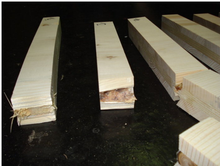
Slika preizkušancev 3-20 po robu, obremenjenih po robu v prečni smeri vlaken. Lom je nastal zaradi velike vrasle grče.
