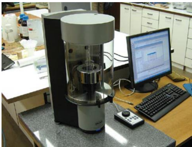
Slika 8: Tenziometer K 100, proizvajalca Krüss GmbH iz Nemčije (foto: Borut Kričej)
