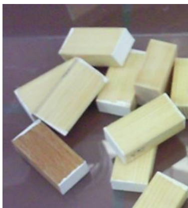
Slika 4: Zaščita vzorcev z čelnim premazom
