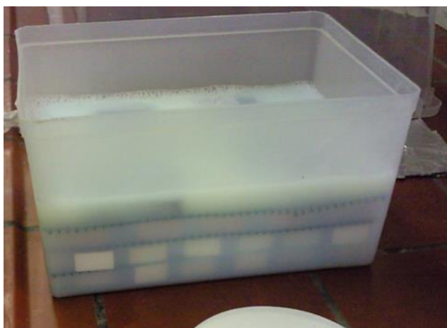
Slika 6: Plastična posoda z vzorci in vodno emulzijo voskov pred impregnacijo
