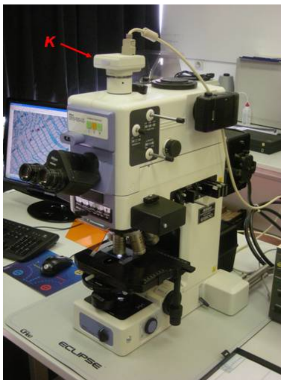
Slika 24: Mikroskop Nikon Eclipse E800 z digitalno kamero Nikon-DS Fi1 (K) s katero s pomočjo računalnika, merimo dimenzije ali štejemo število celic (foto: Željko M.).
