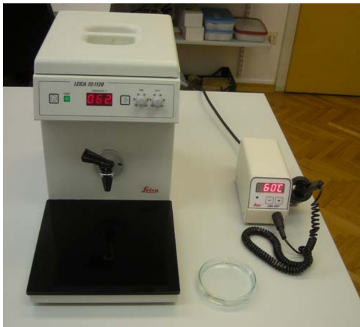
Slika 20: Grelna plošča parafinskega dispenzorja Leica EG 1120 in ogrevana pinceta Leica EG F za obračanje vzorčkov (foto: Željko M.).
