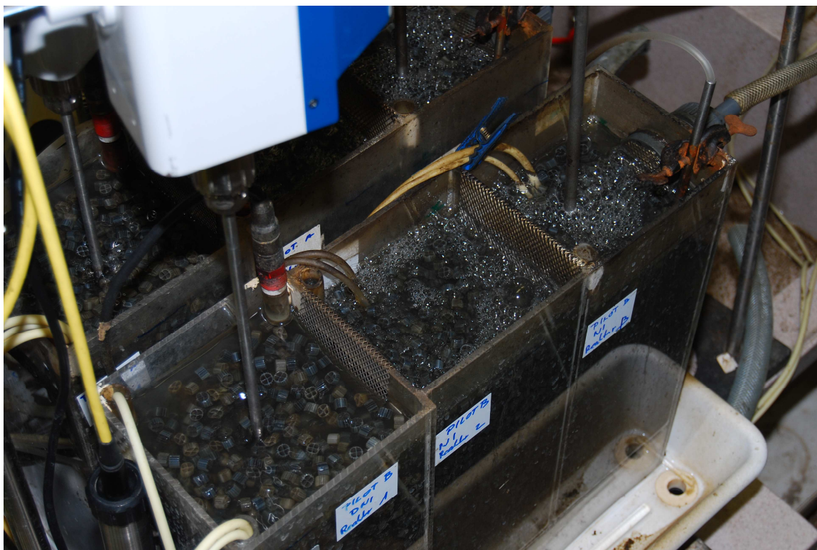
Slika 26: Reaktorji pilotne čistilne naprave, napolnjeni z nosilci Kaldnes K1
