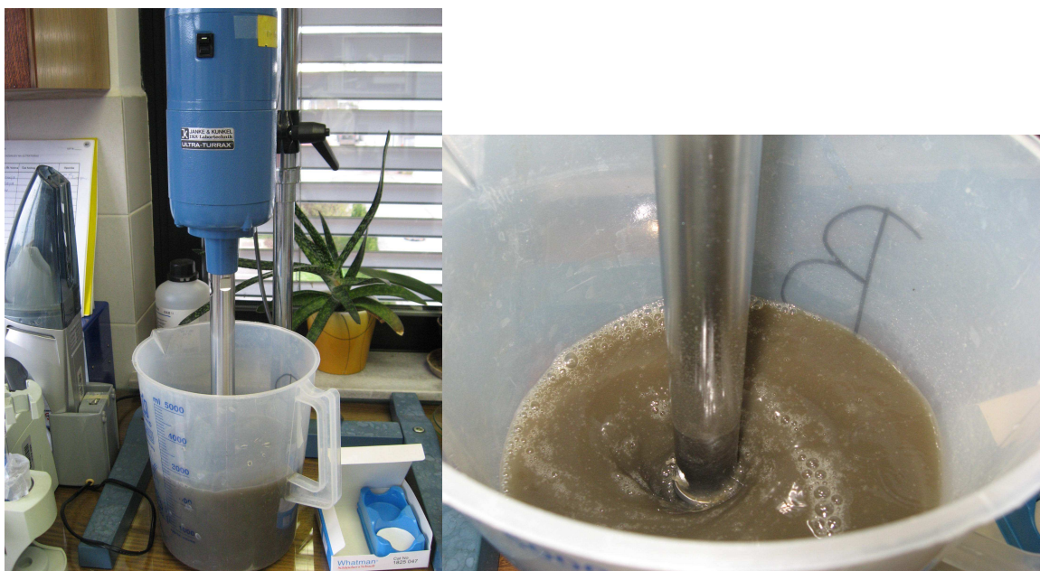
Slika 24: Mehanska dezintegracija blata z mešalom homogenizatorja Kinematica PT 1200E Polytron
