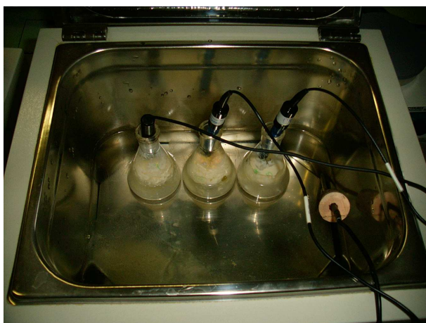
Slika 20: Merjenje pH mleka v termostimirani vodni kopeli.
