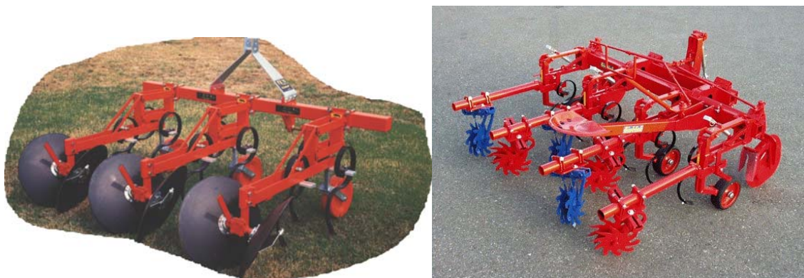
Slika 20: Diskaste osipalne glave (levo) in zvezdasti diski (desno) (Checchi ..., 1995; Landmaschinenkatalog ..., 2002)
