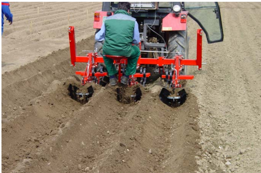
Slika 57: Vlečeni okopalnik z elastičnimi nogačami na paralelogramskem ogrodju in z osipalnimi glavami s krili (VOE)
