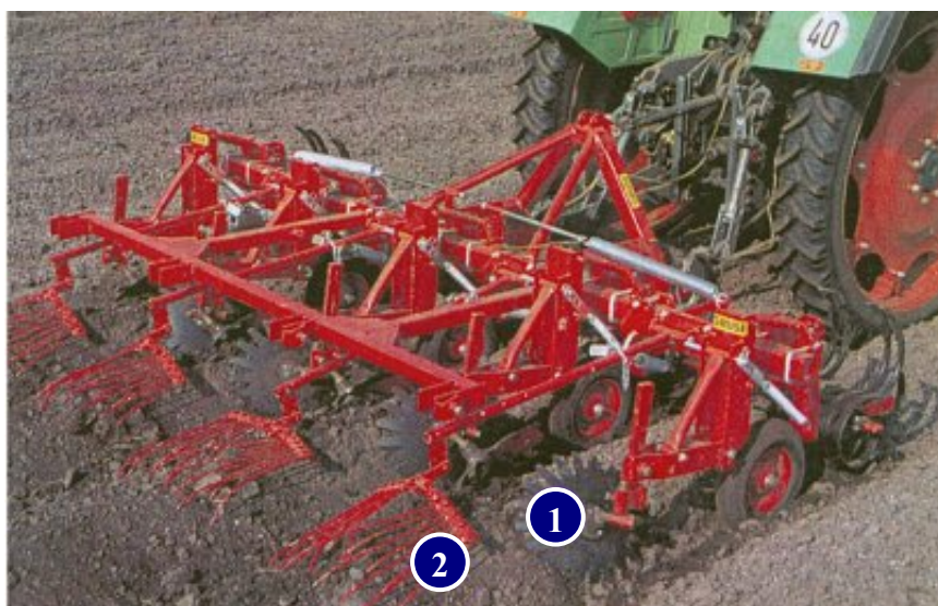
Slika 21: Diskaste nazobčane osipalne glave z dolgimi česali za njimi (Wulf, 1995: 141)
