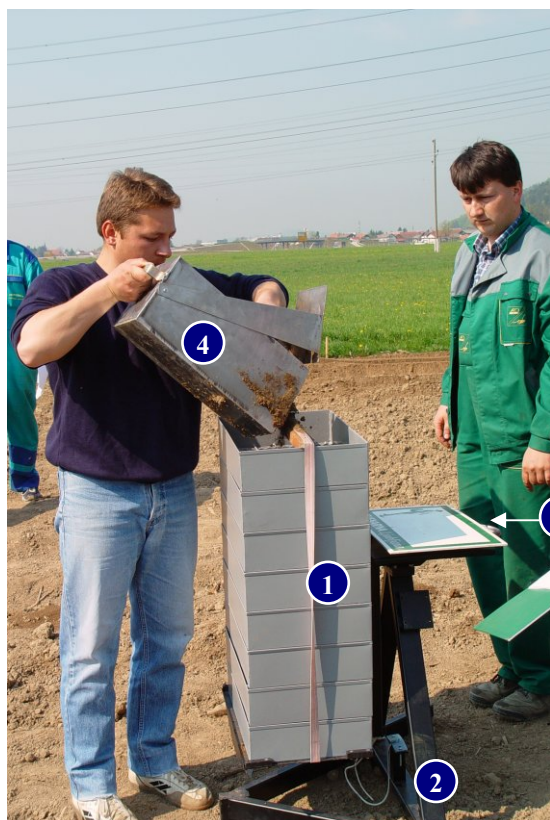
Slika 68: Naprava za sejanje vzorcev tal iz grebena Figure 68: Device for sieving soil samples taken from the ridge
