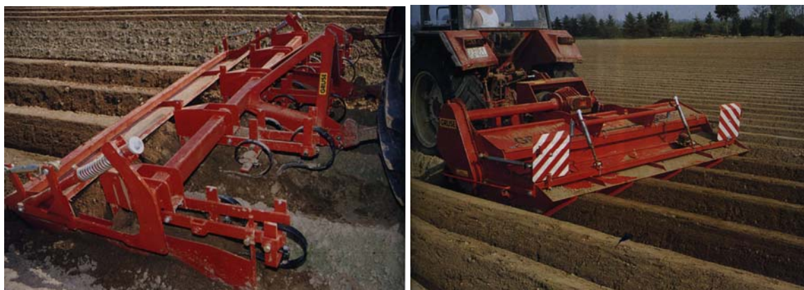
Slika 14: Vlečen (levo) in gnan okopalnik in osipalnik za krompir proizvajalca Gruse (desno) (Gerighausen, 1994: 26, 27)
