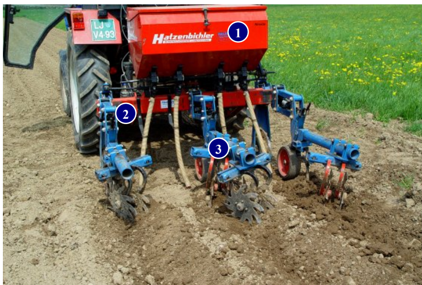
Slika 55: Vlečeni okopalnik s togimi nogačami in zvezdastimi osipalnimi diski (VOT)
