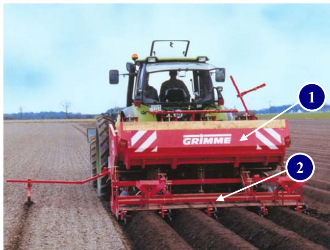
Slika 11: Sajenje krompirja in istočasno osipavanje s prigradenim osipalnikom za dokončno oblikovanje grebenov (Grimme ..., 2003)
