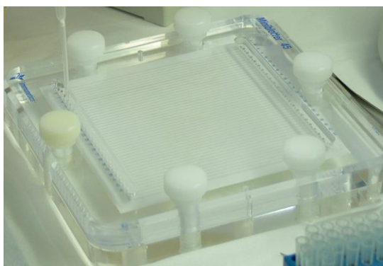
Slika 10: Minibloter in nanašanje vzorcev za metodo spoligotipizacije
