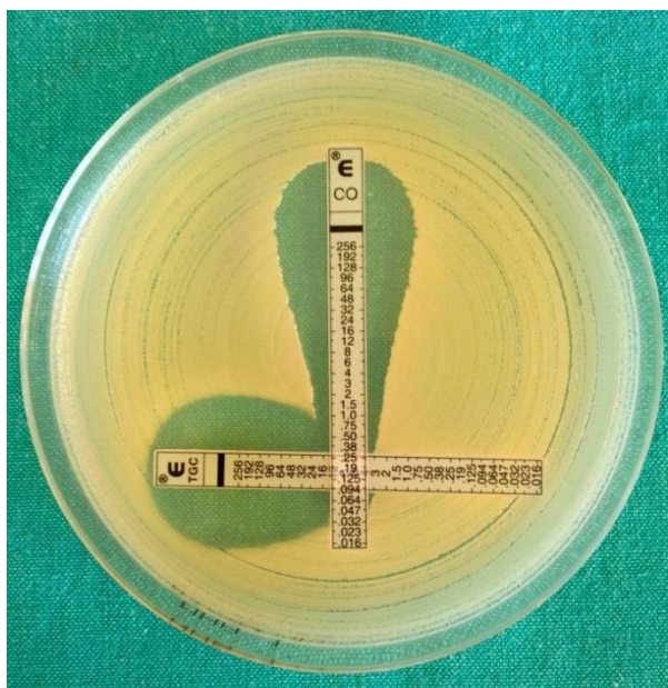
Slika 2: Prikaz metode navzkrižnega seta difuzijskih gradientov in rezultat testiranja sinergije antibiotikov tigeciklina in kolistina
