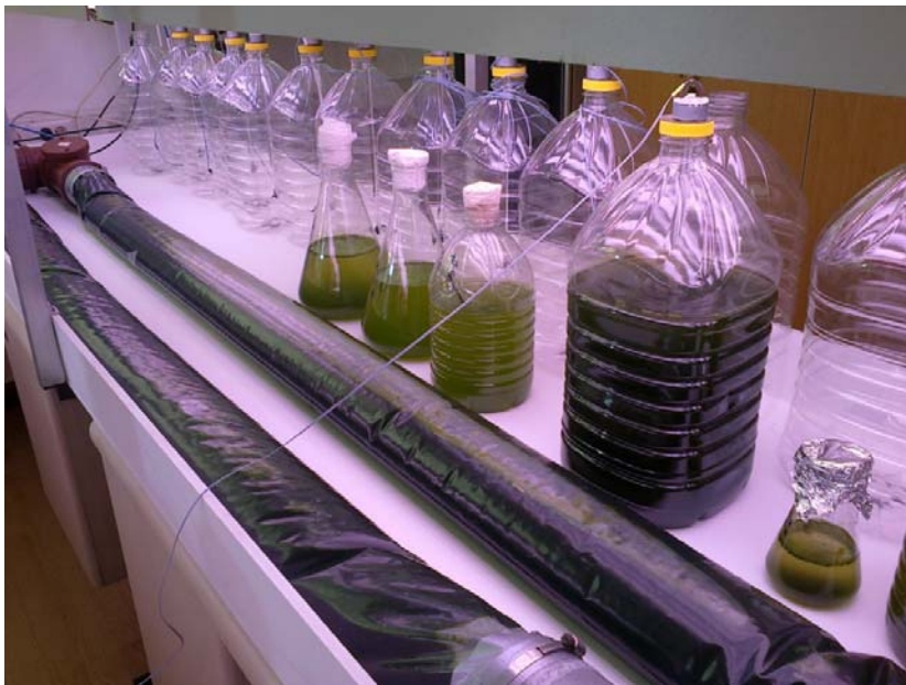
PRILOGA G1: Cevni fotobioreaktor uporabljen za gojenje nedefiniranih mešanih mikroalgnih kultur
