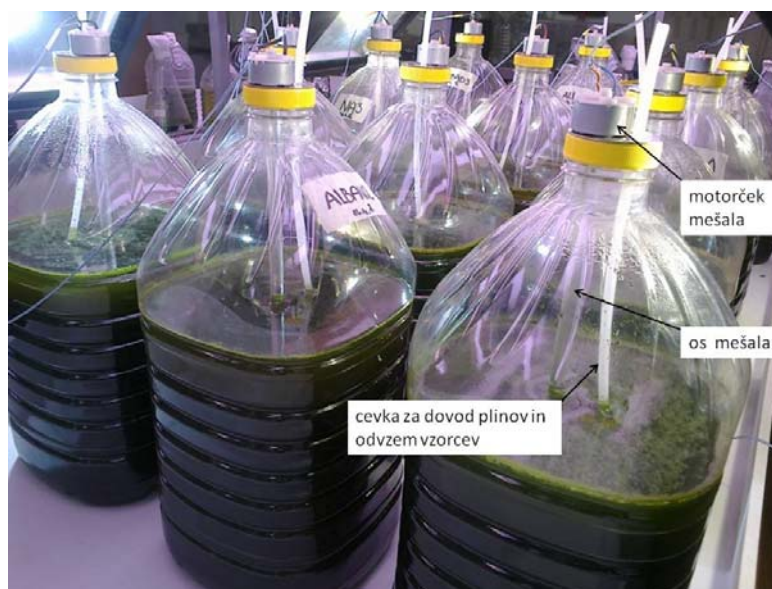
Slika 3: Plastenke in mešala uporabljena v poskusu. Cevke služijo za dovod plinov in odvzem vzorcev.
