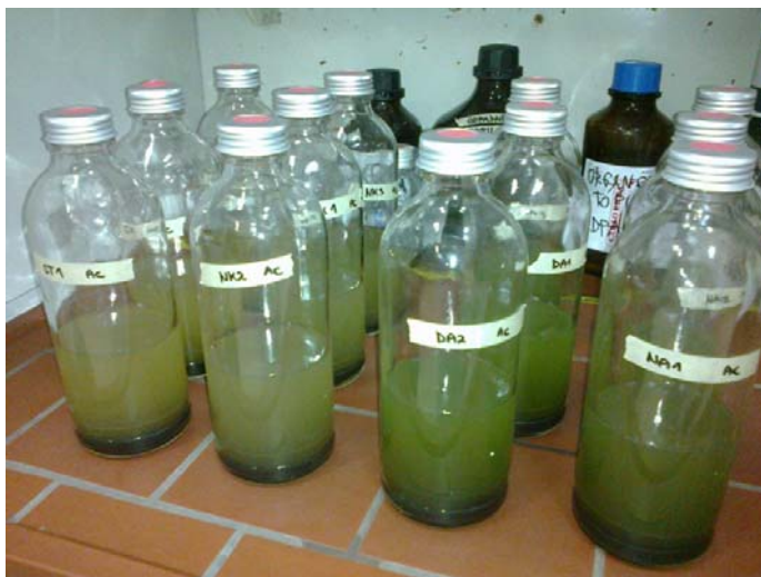
Slika 5: Steklenice s testnimi mešanicami za test metanskega potenciala
