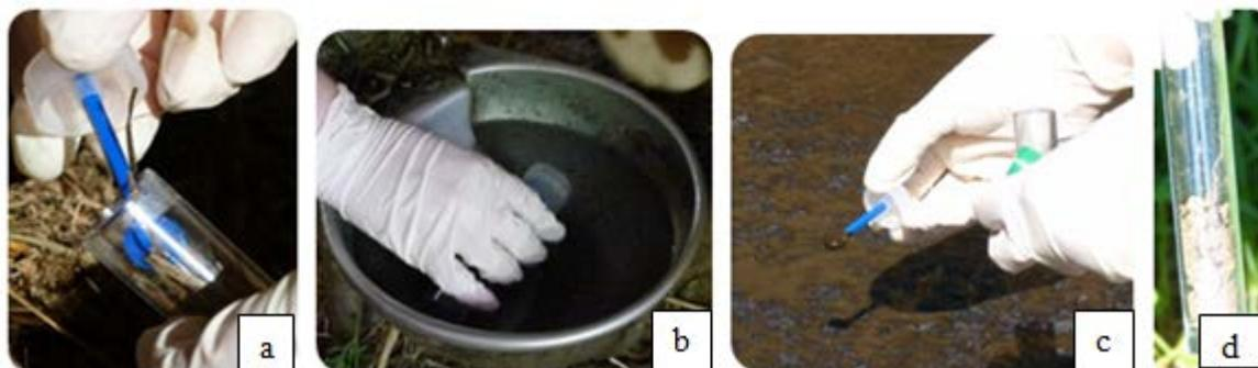
Slika 5: Zbiranje vzorcev iz naravnega okolja po kmetijah: a) vzorčenje silaže, b) vzorčenje vode iz napajalnika, c) vzorčenje gnoja in d) vzorčenje zemlje.
