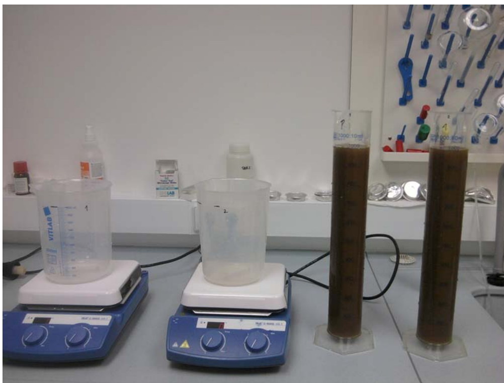
Slika 7: Poskus z dodajanjem izbranih soli in flokulanta v aktivno blato – preizkus usedljivosti blata v litrskih valjih.
