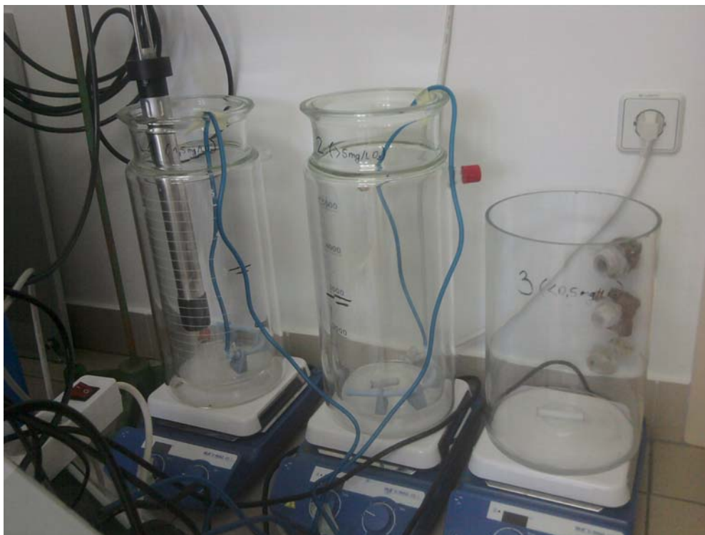
Slika 9: Poskus s prepihanjem blata: priprava bioreaktorskih posod: bioreaktor 1 (prvi levo) z nameščeno sondo, akvarijsko črpalko in magnetnim mešalom, bioreaktor 2 (drugi z leve) z nameščeno akvarijsko črpalko in magnetnim mešalom ter bioreaktor 3, ki ima nameščeno samo magnetno mešalo.
