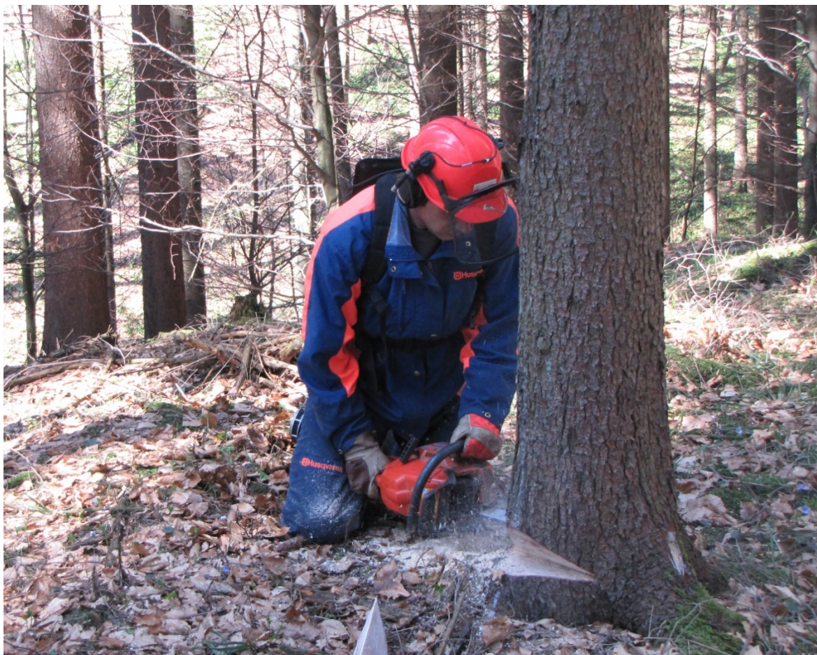
Slika 1: Polno opremljen sekač pri pravilni tehniki podžagovanja drevesa
