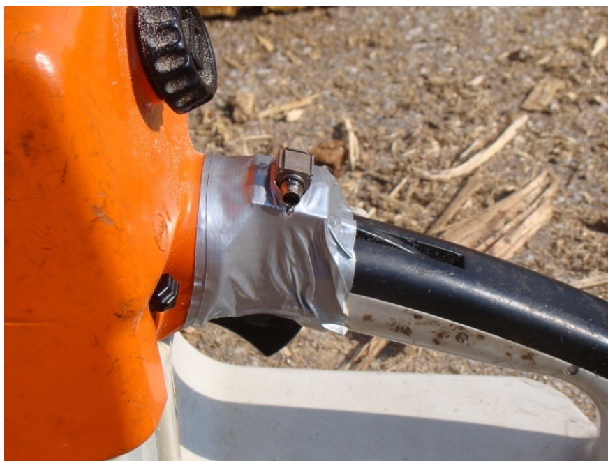
Slika 8: Merilnik tresenja nameščen na vodilnem ročaju motorne žage
