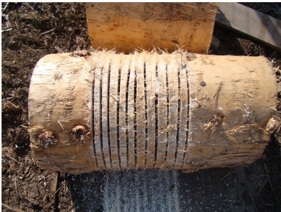
Slika 7: Ležeči odrezek hloda, kjer smo simulirali podžagovanje
