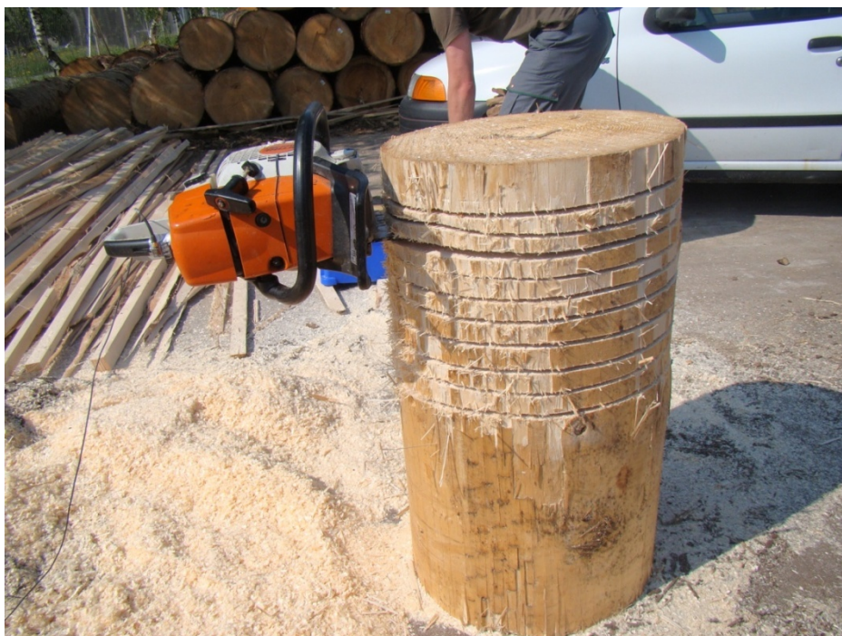
Slika 6: Navpično postavljen odrezek hloda, kjer smo simulirali podžagovanje
