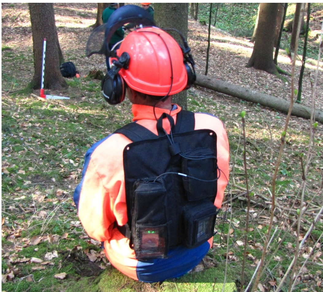
Slika 4: Sekač, opremljen z nahrbtnikom, v katerem so merilne naprave
