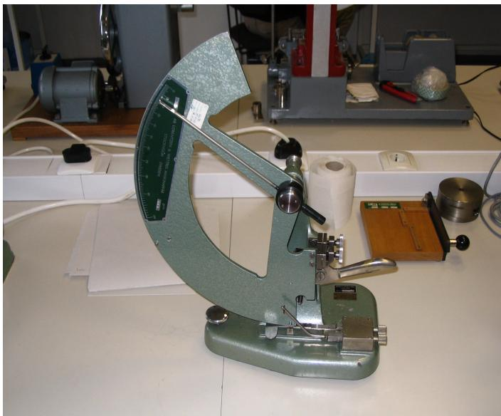
**Slika 3.26:** Merilnik raztržne odpornosti Elmendorf (laboratorij za testiranje vlaknin in papirja, Inštitut za celulozo in papir)
