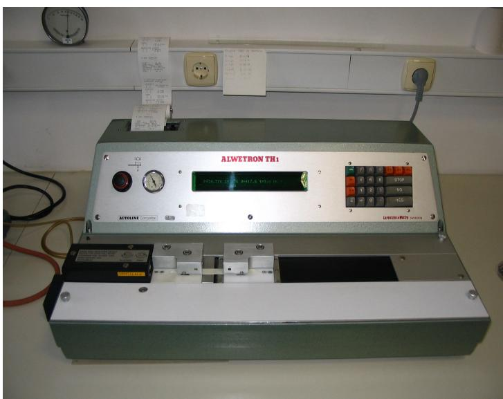
**Slika 3.21:** Dinamometer Alwethron TH-1 (laboratorij za testiranje vlaknin in papirja, Inštitut za celulozo in papir)
