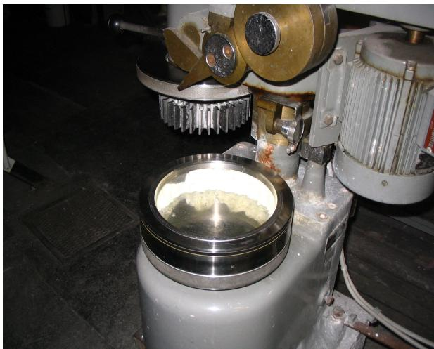
**Slika 3.2:** Laboratorijski mlin PFI (laboratorij za testiranje vlaknin in papirja, Inštitut za celulozo in papir)
