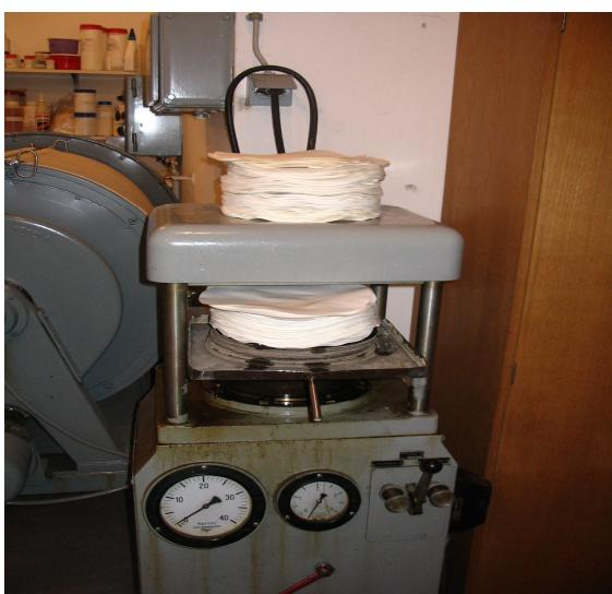
**Slika 3.10:** Hidravlična stiskalnica (laboratorij za testiranje vlaknin in papirja, Inštitut za celulozo in papir)
