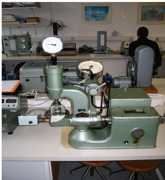
**Slika 3.29:** Merilnik razpočne odpornosti Mullen (laboratorij za testiranje vlaknin in papirja, Inštitut za celulozo in papir)
