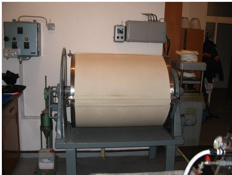
Slika 3.11: Sušilni valj (laboratorij za testiranje vlaknin in papirja, Inštitut za celulozo in papir)
