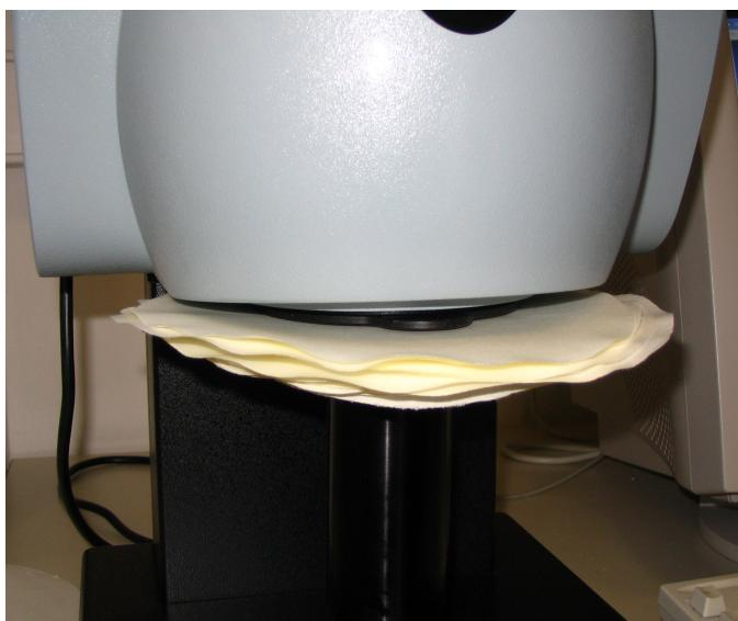
**Slika 3.13:** Optični spektrofotometer Elrepho-Datacolor 450x (laboratorij za testiranje vlaknin in papirja, Inštitut za celulozo in papir)
