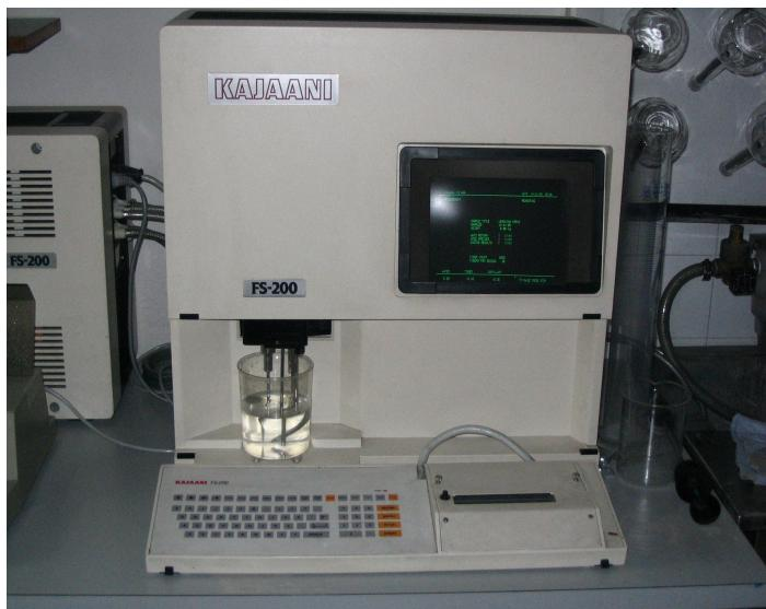
**Slika 3.5:** Merilnik porazdelitve dolžine vlaken Kajaani FS-200 (laboratorij za testiranje vlaknin in papirja, Inštitut za celulozo in papir)
