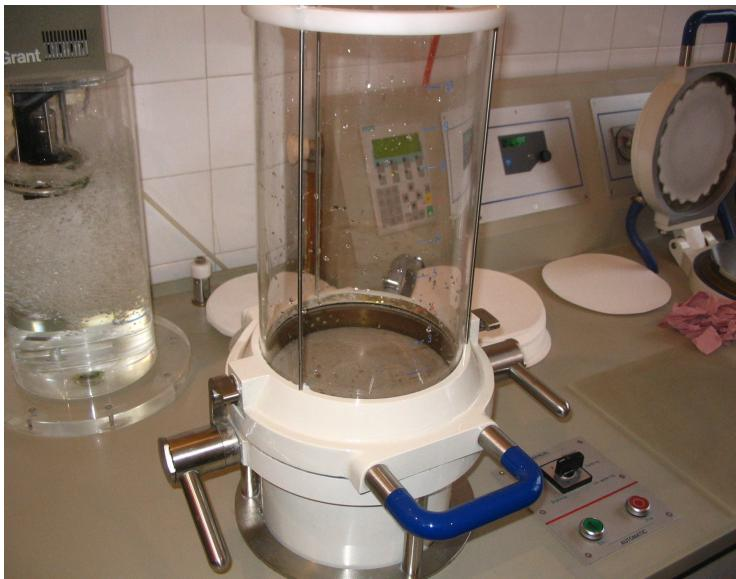
**Slika 3.9:** Laboratorijski oblikovalnik listov Rapid-Koethen (laboratorij za testiranje vlaknin in papirja, Inštitut za celulozo in papir)
