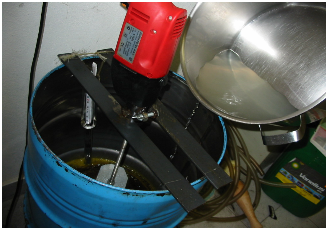
Slika 10: Pri dodajanju natrijevega metoksida, smo pazili na temperaturo in hitrost mešalca
