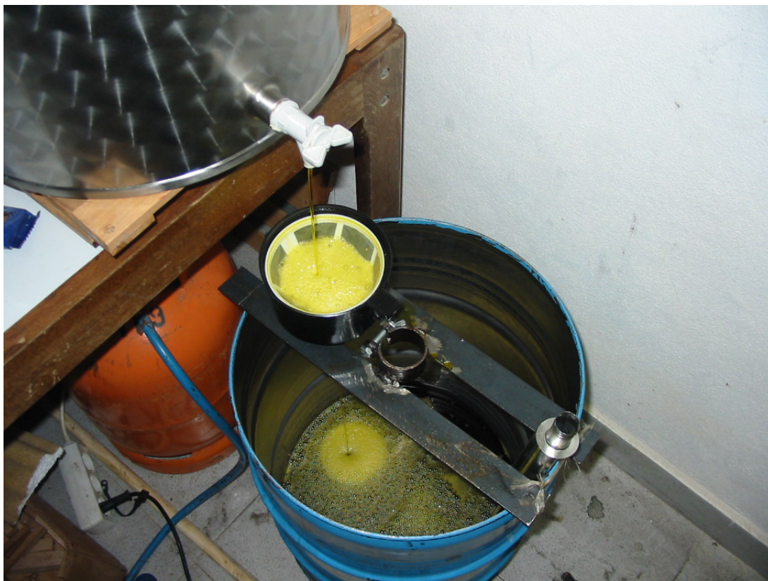
Slika 9: Filtriranje surovega ogrščičnega olja skozi kavni filter
