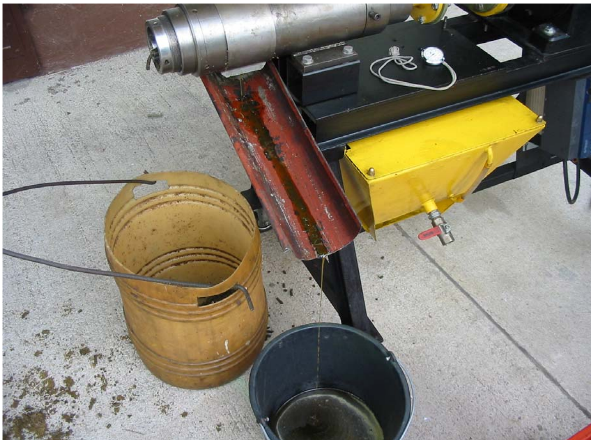
Slika 7: Pridobivanje olja iz semen oljne ogrščice
