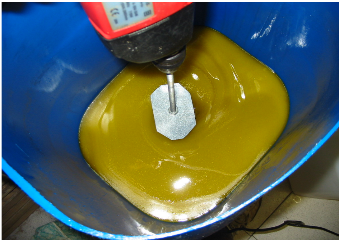
Slika 11: Estrsko fazo in vodo smo mešali do pojava rumene homogene zmesi
