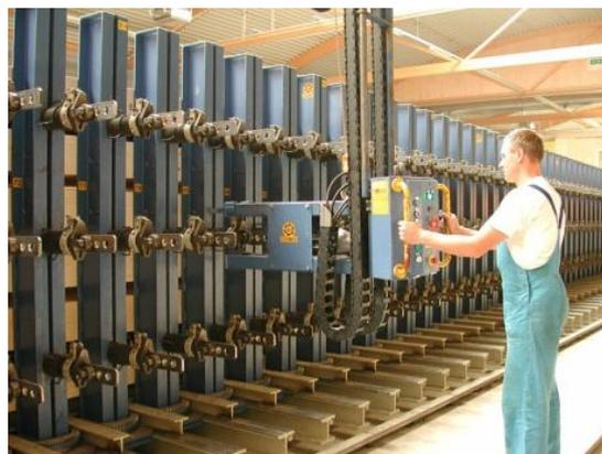
Slika 29: Naprava za stiskanje obdelovanca
