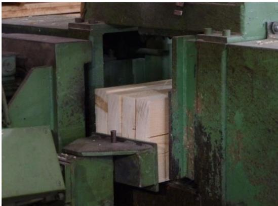
Slika 36: Stroj za izdelovanje zobatih spojev
