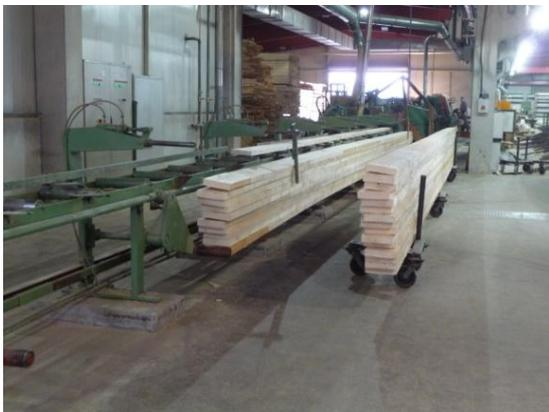
Slika 38: Deske so dolžinsko spojene v lamele
