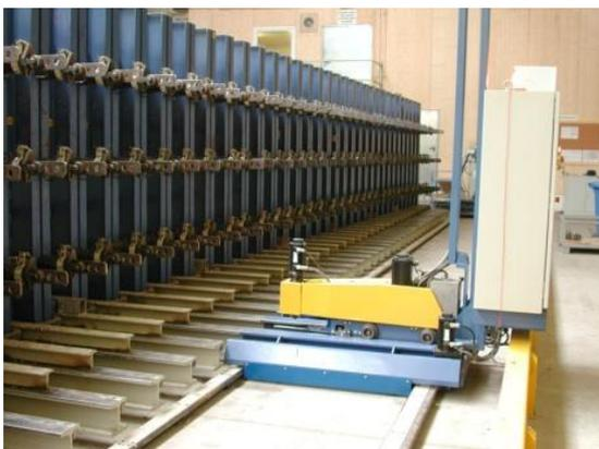
Slika 28: Naprava za nastavitev pozicije stiskalnice
