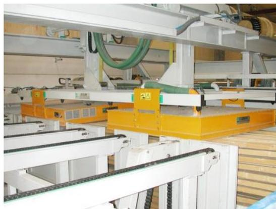
Slika 18: Vakuumski razkladalnik
