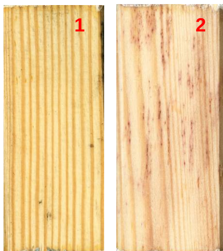
Slika 24: Preizkušanci zaščiteni z emulzijo LGE A B 0,5, izpostavljeni glivam modrivkam 1 in plesnim 2
