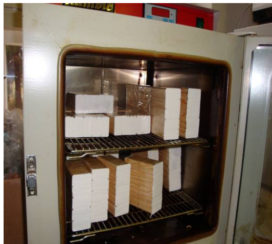
Slika 6: Pripravljen vzorec za test z metodo SIST EN 152-1 (levo) ter sušenje vzorcev (desno)
