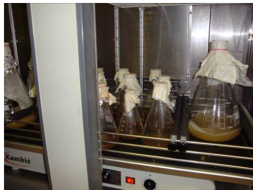
Slika 8: Ohlajanje gojišča v brez prašni komori (levo) in stresanje gliv v stresalniku (desno)
