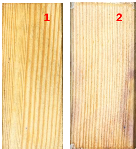
Slika 26: Preizkušanci zaščiteni z emulzijo WE 1 A B 0,5, izpostavljeni glivam modrivkam 1 in plesnim 2
