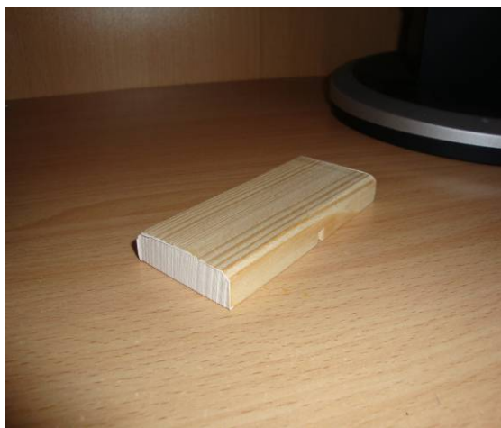
Slika 6: Pripravljen vzorec za test z metodo SIST EN 152-1 (levo) ter sušenje vzorcev (desno)
