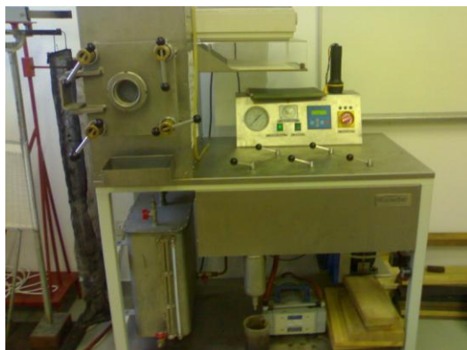
Slika 10: Vakuumsko tlačna impregnacijska komora
