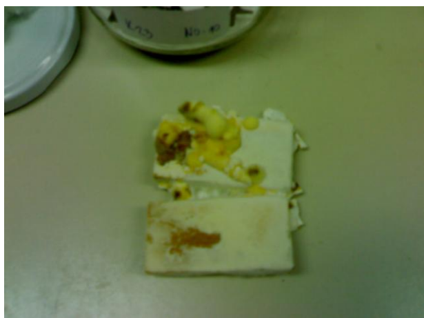
Slika 3: Pisana ploskocevka na vzorcih po 16 tednih v laboratorijskih pogojih
