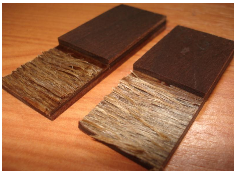
Slika 25: Ocenjevanje loma pri impregniranem vzorcu
