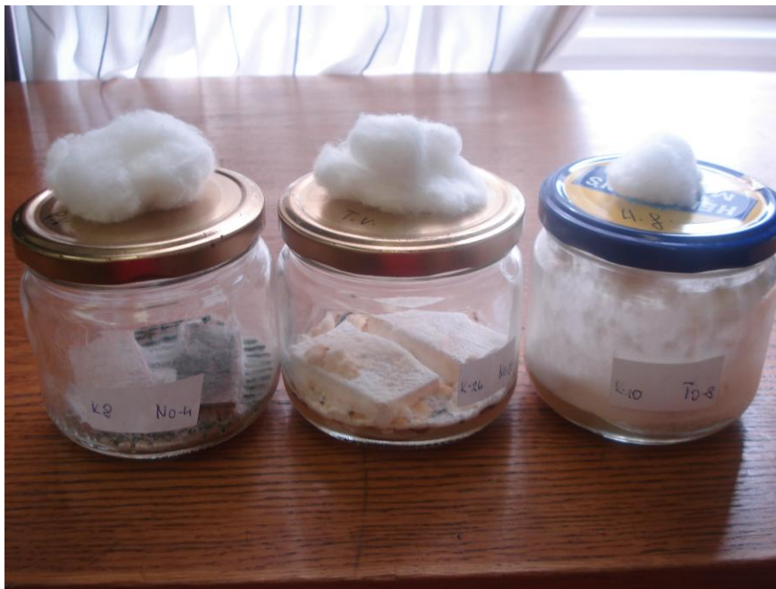
Slika 45: Primerjava vitalnost gliv na vzorcih po 13 tednih. Levo: bela hišna goba; na sredini: pisana ploskoceвка, desno ogljena kroglica
