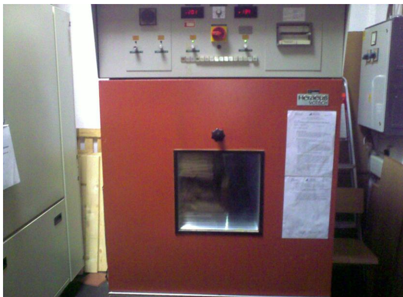
Slika 13: Klimatska komora za kondicioniranje lesa v normalnih pogojih pri T = 20\text{ °C} , RZV = 65 %
