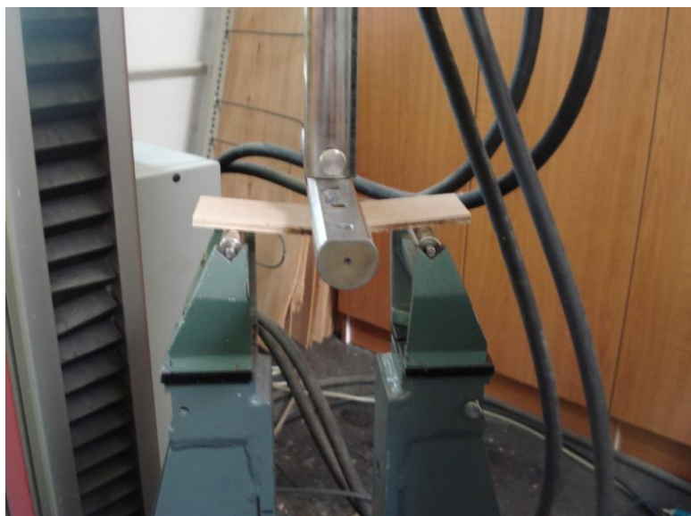
Slika 26: Ugotavljanje modula elastičnosti in upogibne trdnosti z univerzalnim testnim strojem Zwick Z100
