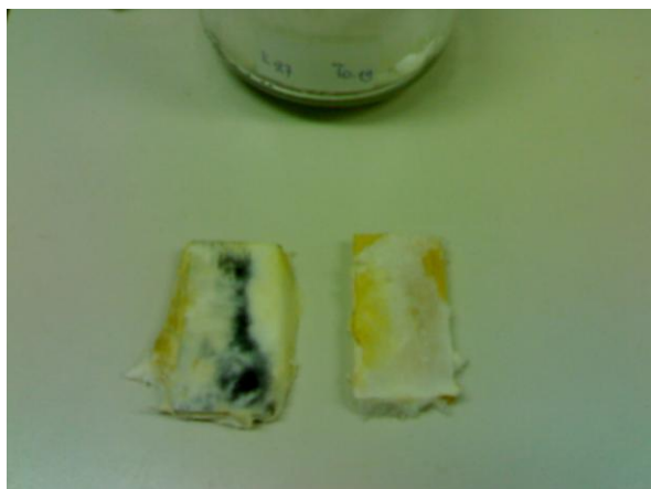
Slika 4: Ogljena kroglica na vzorcih po 16 tednih v laboratorijskih pogojih
