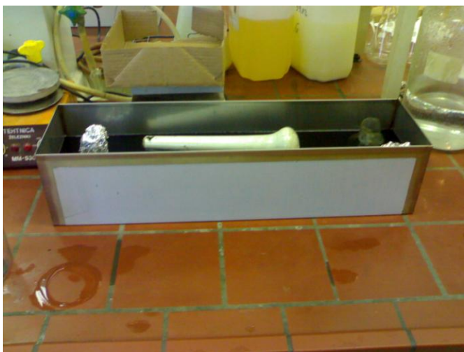
Slika 8: Impregnacija furnirjev v banjici s Silvanolinom
