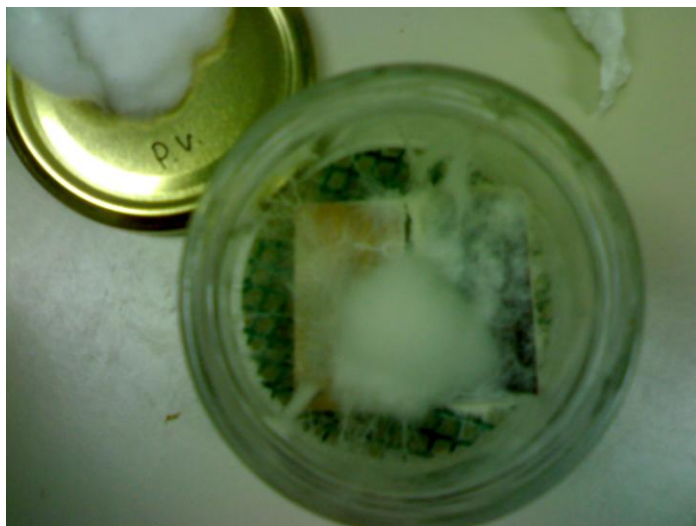
Slika 1: Bela hišna goba na vzorcih po 16 tednih v laboratorijskih pogojih
