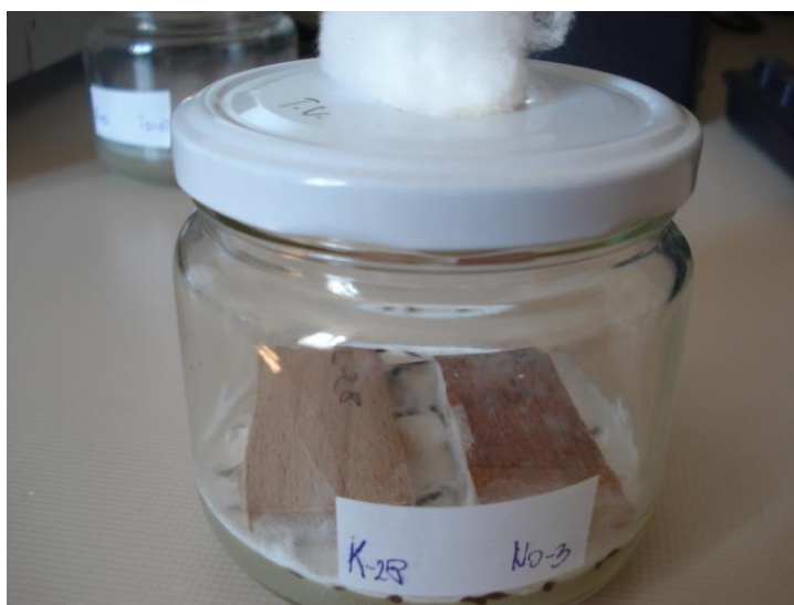
Slika 29: Neimpregniran in kontrolni vzorec en teden po izpostavitvi glivi Trametes versicolor
