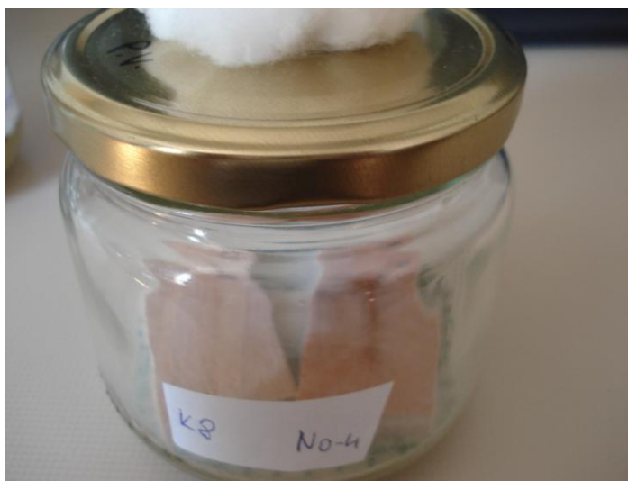
Slika 30: Neimpregniran in kontrolni vzorec en teden po izpostavitvi z glivo Poria vaillantii
