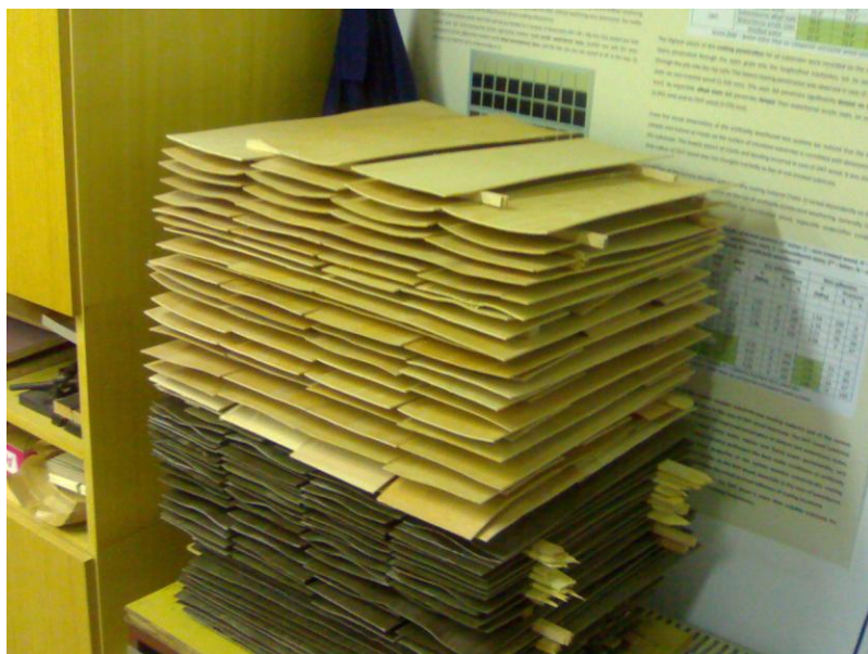
Slika 11: Listi impregniranega in neimpregniranega furnirja v klimatizirani sobi pri T= 22 °C, RZV= 55–65 %
