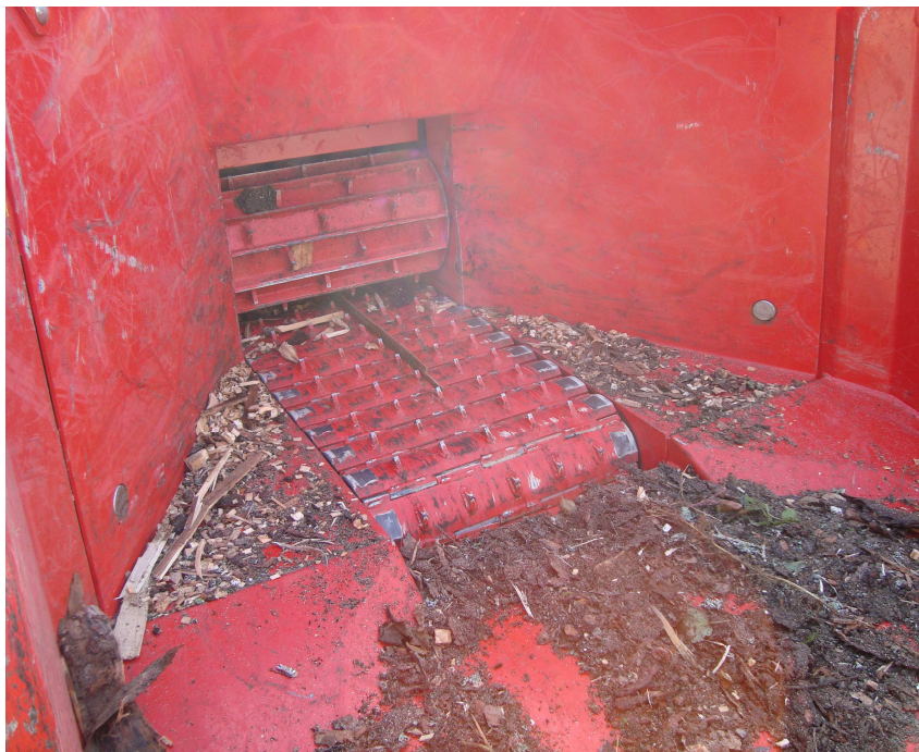
Slika 9: Vstopna odprtina sekalnika (foto: Bajželj, 2010)
